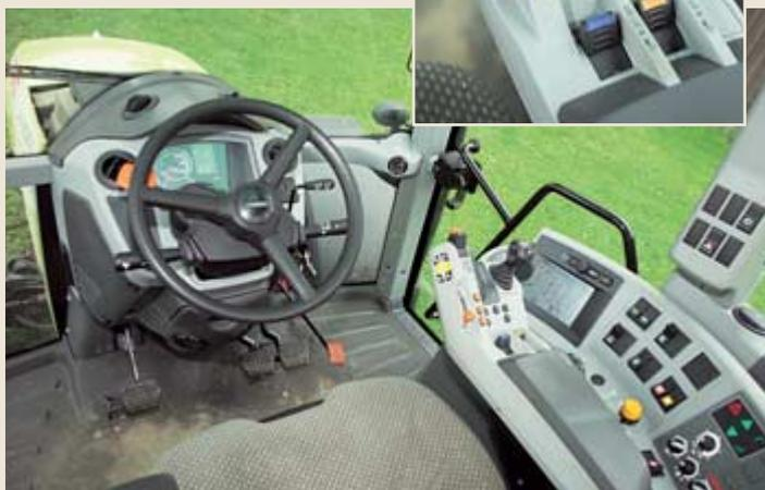
Mit dem „Drivestick“ vorne an der Armlehne kontrolliert der Fahrer alle Gänge. Das Cebis-Terminal fuhr im Test zu langsam hoch (1/2 Minute).
