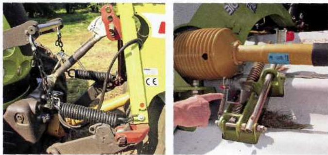
Über ein Schnellwechsel-Dreieck wird das Frontmäherwerk mit dem Traktor verbunden. Der Mähbalken des Frontmäherwerkes wird über zwei starke Federn entlastet. Das Gewicht wird so auf die Traktor-Vorderachse übertragen. Links neben dem Anbaubock befindet sich die Abstellverriegelung (r.). Zum Anbau und Abbau des Mähwerkes muss der Riegel eingeklappt sein.
