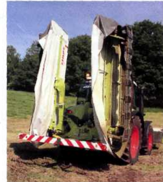
Die endlagengedämpften Heckmäherwerke ragen bei der Fahrt etwas nach innen. Das verhindert böse Überraschungen auf der Straße. Am Feld wird die mechanische Transportsicherung per Seilzug gelöst. Am Hang klappen die beiden Mähwerke immer synchron aus.
