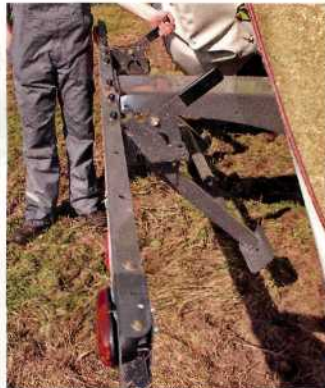
Rote Markierungen an der Außenseite der Heckmäherwerke erleichtern das Anschlussfahren. Stützfüße hinten und vorne tragen das Mähwerk nach dem Abbauen. Die hinteren Abstützungen (r.) werden über einen Hebel in die gewünschte Position gebracht. Das Mähwerk kann übrigens auch hochgeklappt abgestellt werden. Die Beleuchtung an der Lichtleiste rechts und links ist via Gummipuffer federnd angebracht.
