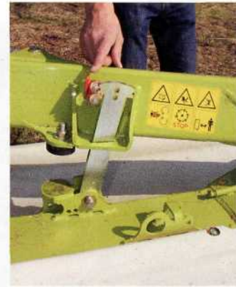
Das Frontmäherwerk pendelt um ein stabiles mittiges Drehgelenk (l.o.). Wurde die mechanische Anfahrtsicherung ausgelöst, muss der Fahrer zurücksetzen, damit die Klinke (l.m.) wieder einrastet. Die Heck-Mäheinheiten sind in ihrem Schwerpunkt aufgehängt (l.u.). Die Drehpunkte erlauben eine optimale Bodenadaptation. Durch den roten Pfeil (r.o.) kann auch vom Fahrersitz aus die richtige Unterlenkerposition angesteuert werden.
