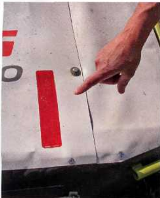
Rote Markierungen an der Außenseite der Heckmäherwerke erleichtern das Anschlussfahren. Stützfüße hinten und vorne tragen das Mähwerk nach dem Abbauen. Die hinteren Abstützungen (r.) werden über einen Hebel in die gewünschte Position gebracht. Das Mähwerk kann übrigens auch hochgeklappt abgestellt werden. Die Beleuchtung an der Lichtleiste rechts und links ist via Gummipuffer federnd angebracht.
