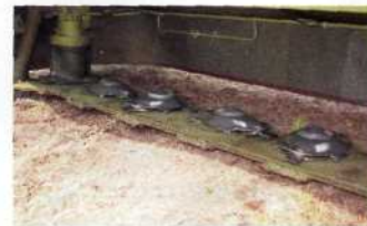
Sind die Schutztücher hochgeklappt, ist der Mähbalken für den Messerwechsel oder andere Wartungs- und Reinigungsarbeiten sehr gut zu erreichen.
