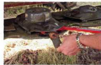
Der serienmäßige Klingenschnellwechsler ist einfach und bewährt. Die Klemmfeder wird mit dem eingeschweißten Messerbolzen per Hebel angehoben.
