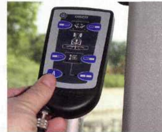
Auf dem CST-Terminal zeigen Leuchtdioden die aktivierten Funktionen an.
