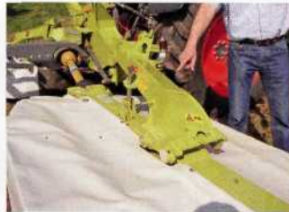
Das Frontmäherwerk pendelt um ein stabiles mittiges Drehgelenk (l.o.). Wurde die mechanische Anfahrtsicherung ausgelöst, muss der Fahrer zurücksetzen, damit die Klinke (l.m.) wieder einrastet. Die Heck-Mäheinheiten sind in ihrem Schwerpunkt aufgehängt (l.u.). Die Drehpunkte erlauben eine optimale Bodenadaptation. Durch den roten Pfeil (r.o.) kann auch vom Fahrersitz aus die richtige Unterlenkerposition angesteuert werden.
