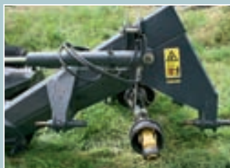
Длинный карданный вал с муфтой свободного хода имеет хороший держатель, две опоры с пружинной нагрузкой просто откидываются. Однако здесь явно необходима надежная маркировка трех масляных шлангов, поскольку гидравлическая система выполнена очень сложно.
