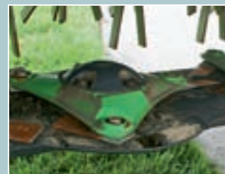
Косилочные диски имеют по три прикрученных ножа каждый, система быстрой замены ножей (пока) не поставляется. Но доступ, благодаря поворотной защите, превосходный. Кроме того, имеется бокс для запасных ножей.
