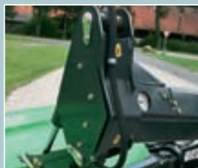
Косилочный брус с гидравлической разгрузкой имеет толкаемую навеску, и при столкновении с препятствием может отклоняться только вверх. Для регулировки опорного давления нужно всего лишь открыть кран; к сожалению, считывать показания манометра из кабины трактора нельзя.
