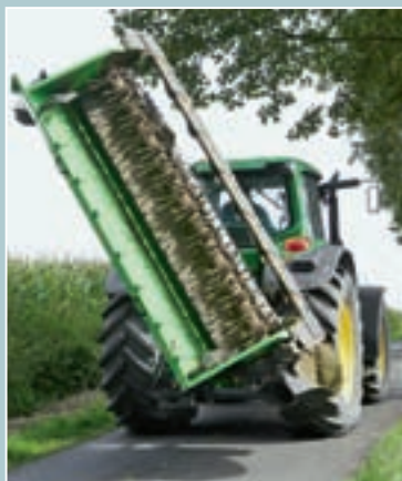
Косилка DiscMaster 632 T складывается на 110° и отличается равномерным распределением веса и незначительной разгрузкой передней оси. Освещение является опциональным оснащением.
