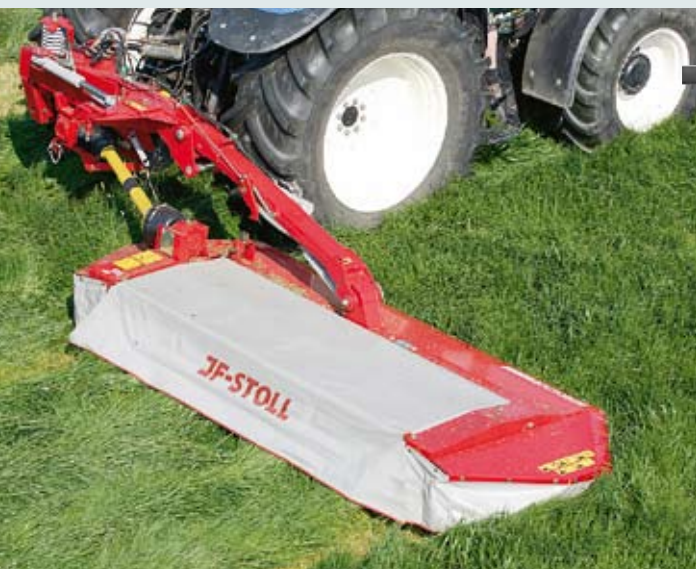
Косилка GX 3205 фирмы JF-Stoll при ширине захвата 3,10 м оснащается восемью косилочными дисками, вращающимися парно. Они имеют большие цилиндрические шестерни, которые расположены в один ряд с остальными цилиндрическими шестернями. Потребляемая мощность была средней – от 20 до 21 кВт. В случае перегрузки, валы привода дисков могут обрестись. И хотя диск отсоединяется, зона привода при этом остается герметичной, поэтому прикрепленный механизм привода можно просто заменить.
