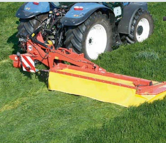
Косилка Fella SM 310 TL имеет всего лишь шесть косилочных дисков при ширине скашивания три метра. Путем замены двух приводных механизмов парное вращение дисков может быть изменено на вращение к центру. Это является возможным благодаря конструкции привода с шестигранным валом сзади на косилочном бруске, который посредством углового редуктора с конической шестерней приводит в движение смещенные вперед косилочные диски. Место запланированного излома на заднем валу одновременно служит защитой от перегрузок. Потребляемая мощность косилочного бруса показала средний результат – 20-21 кВт.
