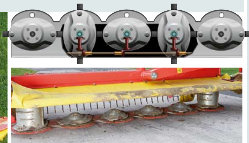
Косилка Fella SM 310 TL имеет всего лишь шесть косилочных дисков при ширине скашивания три метра. Путем замены двух приводных механизмов парное вращение дисков может быть изменено на вращение к центру. Это является возможным благодаря конструкции привода с шестигранным валом сзади на косилочном бруске, который посредством углового редуктора с конической шестерней приводит в движение смещенные вперед косилочные диски. Место запланированного излома на заднем валу одновременно служит защитой от перегрузок. Потребляемая мощность косилочного бруса показала средний результат – 20-21 кВт.
