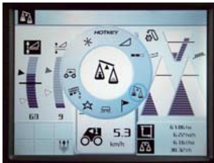
Die Auswahl am Cebis-Drehschalter ist gleich geblieben (oberes Bild), neu ist der Direktzugriff auf viele Funktionen über den „Hotkey“-Wahlschalter. Dadurch konnte die Zahl der Taster auf der Armlehne deutlich reduziert werden (unteres Bild).
