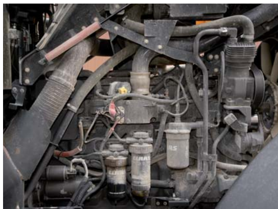
Der 6,8-l-Sechszylinder von Deere Power Systems überzeugte mit seiner Leistung und dem niedrigen Dieselverbrauch. Die Zylinderkopfdichtung wurde allerdings nach knapp 1200 Stunden einmal vorsorglich getauscht.
