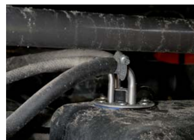
Der Geber der Tankuhr bekam einen zusätzlichen Widerstand, damit der Zeiger bei Kurvenfahrten trotz mehr als halb vollem Tank nicht auf „null“ fällt.
