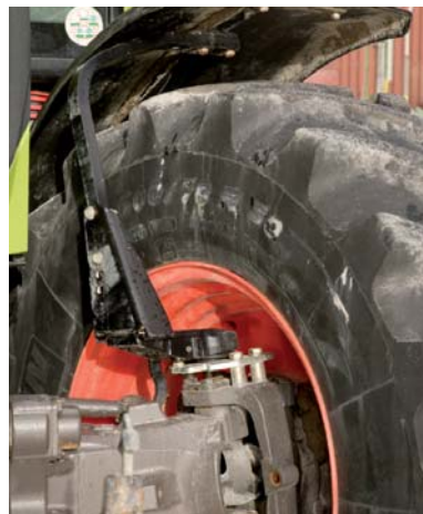
Die Gummis der Kotflügel und die große Schraube der Halterung fielen wohl dem Erdbau zum Opfer und mussten erneuert werden. Im Einsatz auf Acker und Straße ist das kein bekanntes Problem.
