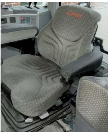
Nach nur gut 1.800 Stunden war der Grammer Maximo defekt und wurde kostenlos gegen einen neuen Sitz getauscht. Aber auch hier ist die linke Armlehne bereits wieder gebrochen.
