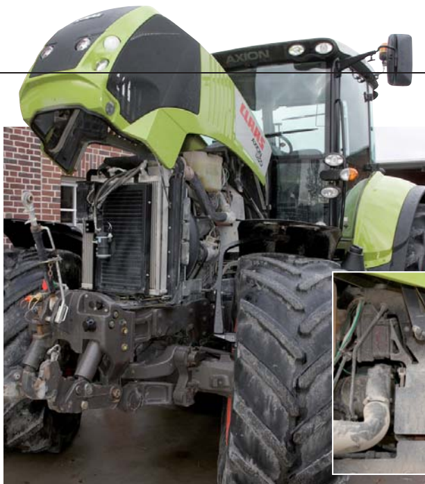
Die große einteilige Haube ermöglicht einen sehr guten Zugang zu den Kühlern. Der Gasdruckdämpfer (kleines Bild) wurde nach knapp 1000 Stunden einmal erneuert.
