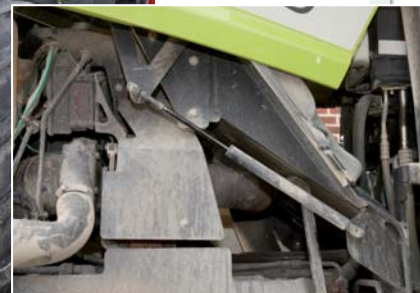
Die große einteilige Haube ermöglicht einen sehr guten Zugang zu den Kühlern. Der Gasdruckdämpfer (kleines Bild) wurde nach knapp 1000 Stunden einmal erneuert.
