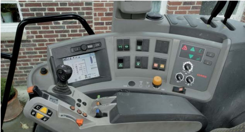
Trotz der vielen (Einstell-)Möglichkeiten auch in dem farbigen Cebis-Terminal ist die Grundbedienung gerade für Aushilfsfahrer einfach. Die Gänge und Lastschaltstufen werden mit dem kleinen „Drive-Stick“ vorne in der Armlehne geschaltet.
