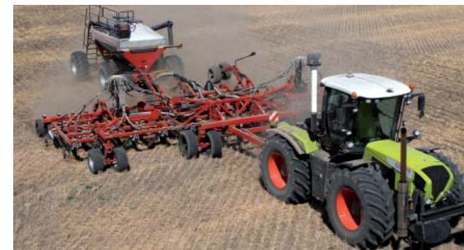
Благодаря бесступенчатому приводу, водитель может регулировать скорость движения независимо от оборотов двигателя.
