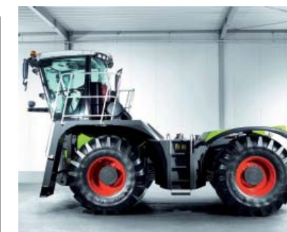
У Xerion Saddle Trac кабина расположена спереди над двигателем.
