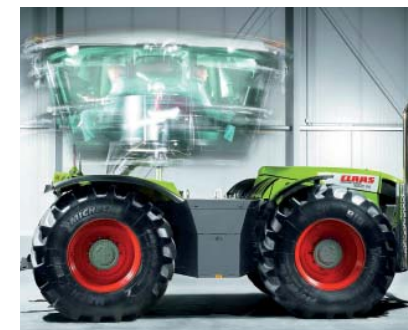
Кабину варианта Xerion Trac VC можно развернуть на 180 градусов.
