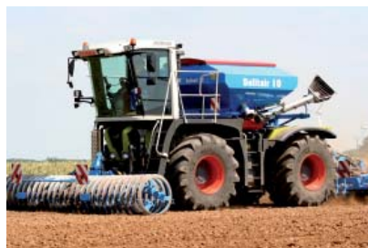
В варианте Saddle Trac место за кабиной может быть использовано, например, для семенного бункера.
