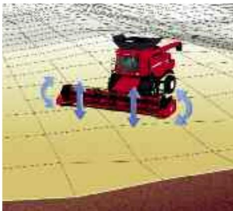
▲ **Точное отслеживание рельефа** — задача системы *Terrain Tracking*, благодаря которой жатка всегда поддерживается в положении, параллельном поверхности почвы.
