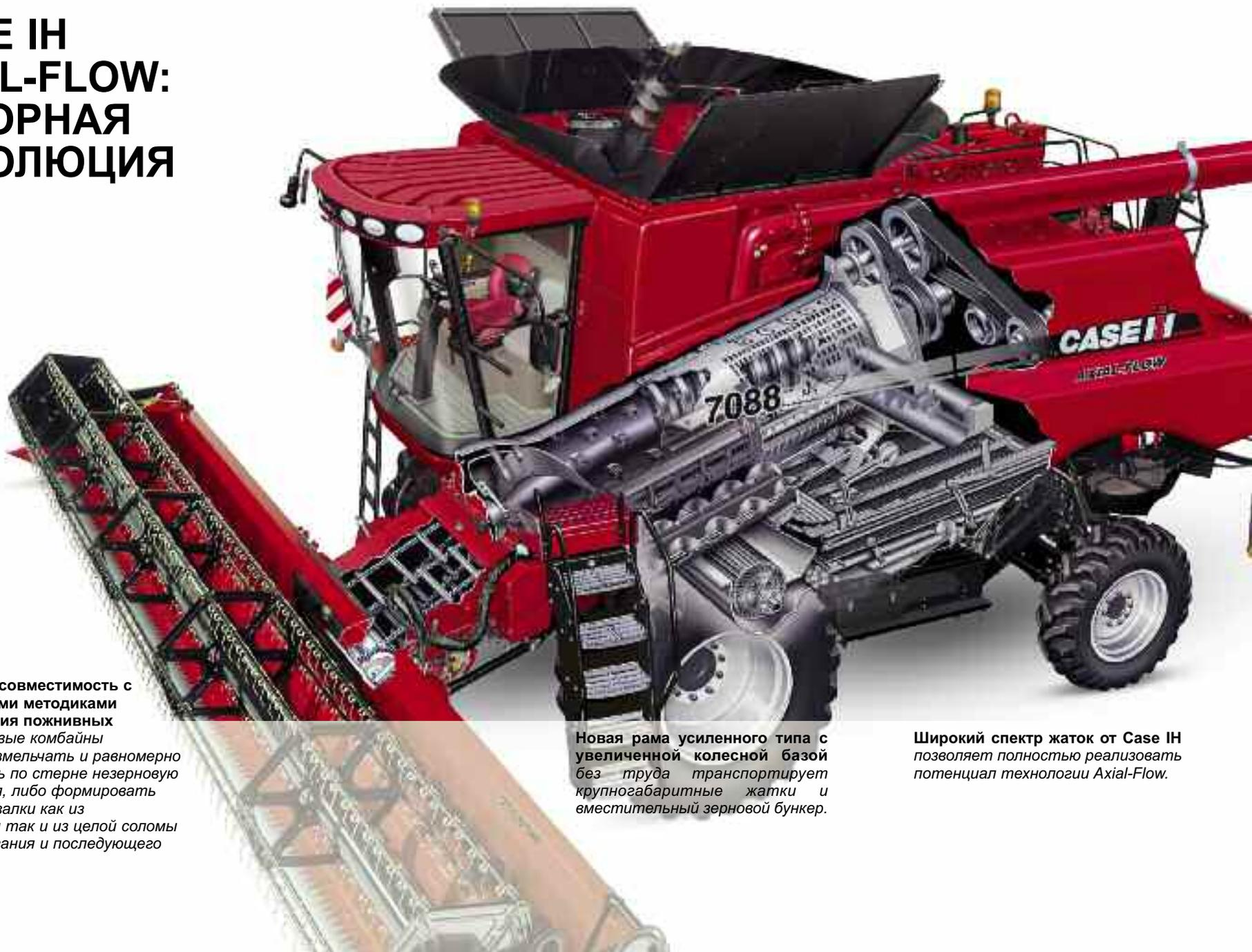
Улучшенная совместимость с современными методиками использования пожнивных остатков. Новые комбайны позволяют измельчать и равномерно распределять по стерне незерновую часть урожая, либо формировать аккуратные валки как из измельченной так и из целой соломы для просушивания и последующего прессования.
