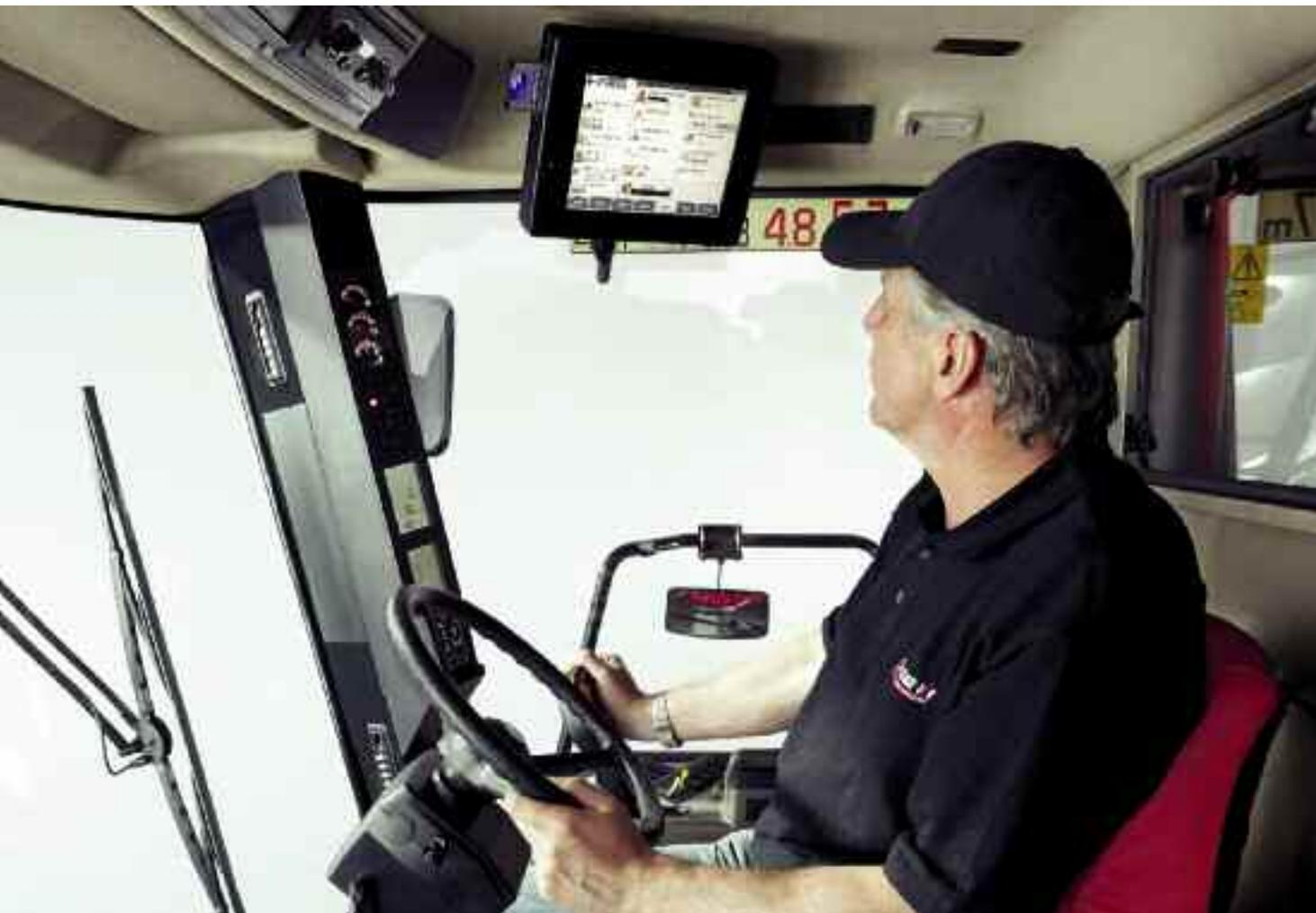
**Эргономичный многофункциональный рычаг** обеспечивает удобное управление различными системами комбайна. В частности, он позволяет поднимать жатку и возвращать ее в рабочее положение; регулировать рабочий угол наклона жатки; перемещать мотовило в вертикальном и продольном направлениях; откидывать и включать выгрузной шнек, производить экстренную остановку жатки; а также управлять работой полотненного транспортера и позиционировать направляющие щитки.
