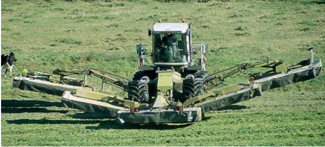
На поворотах пять косилок одна за другой приподнимаются посредством последовательного управления.
