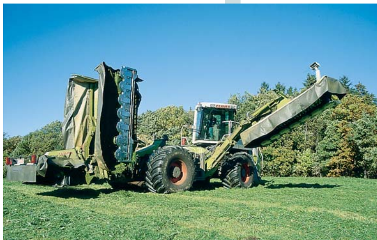
Благодаря изобретательному последовательному управлению, рабочие органы косилки складываются и убираются, а кабина разворачивается на 180°.
