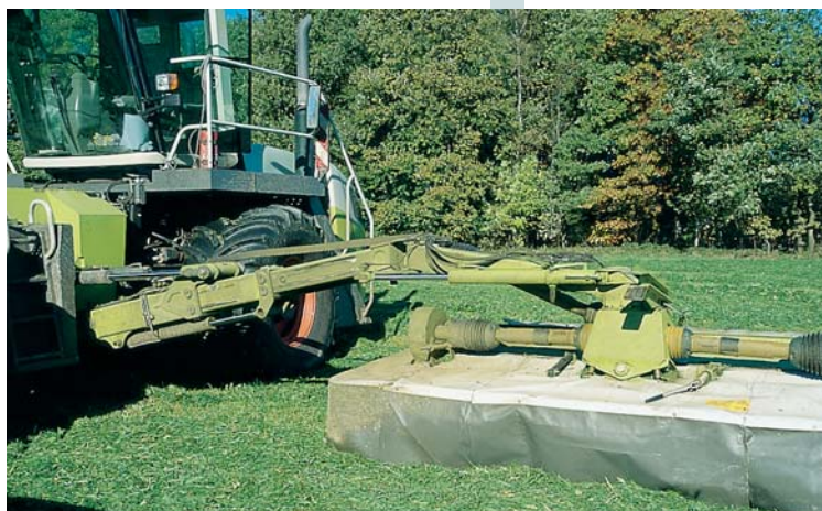
Обе боковые дисковые косилки установлены на специальных телескопических стрелах. Давление на опору регулируется пневмогидравлическим способом из кабины.
