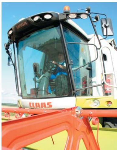
Кабина комбайна была перенята от трактора серии Hexion и подвергнута доработкам.
