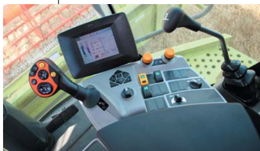
Как и у комбайна Lexion, в оснащение Tucano входит терминал Cebit, который облегчает настройки и наблюдение комбайна.
