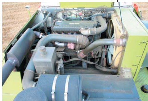
Как и у комбайна Lexion двигатель у Tisano расположен позади зернового бункера. Это облегчает техобслуживание. Кроме того водитель может заглядывать в бункер.
