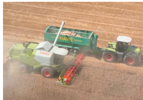
Машины Tisano оснащены зерновым бункером вместимостью до 9 000 л. Благодаря длинному разгрузочному шнеку возможно перегрузение даже во время движения.
