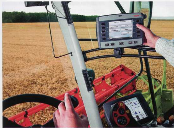
Das Cebis Mobile mit dem Cemos ist hier über dem Mähdrescherterminal platziert. Über die Montagerohre kann man es weiter nach hinten schieben.
