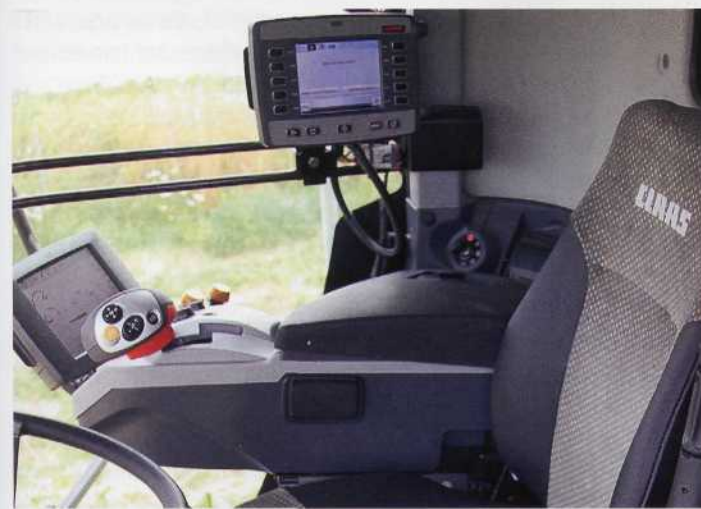
Das Cemos läuft im Zusatzterminal „Cebis Mobile“, das mit anderer Software auch für andere Einsätze z. B. als ISO-Bus-Terminal auf dem Schlepper genutzt werden kann.
