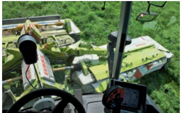
...а обзор косилочных агрегатов просто отличный. Обслуживание косилок выполняется с использованием функциональных кнопок на рычаге движения Xerion.
