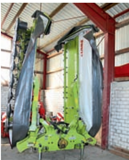
Опорные стойки практичны и стабильны – для хранения косилок требуется совсем немного места. Предусмотрены также держатели карданных валов, и масляные шланги обозначены подobaющим образом – все отлично!
