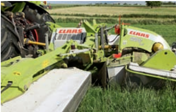
При задней навеске опорное давление фронтальной косилки на почву также регулируется системой ActiveFloat с помощью гидроцилиндра...
