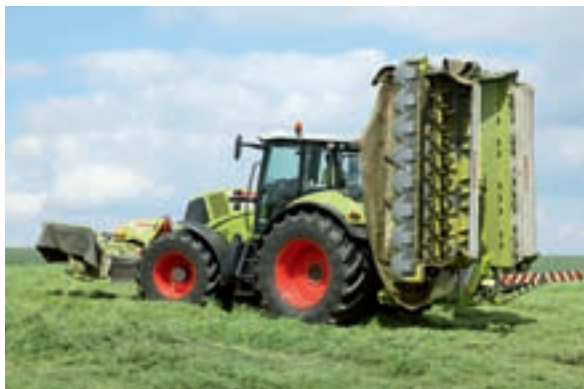
Переход с транспортного в рабочее положение при обоих вариантах навески длится не дольше минуты, а, благодаря гидравлически складывающимся защитным фарукам, даже не нужно выходить из кабины. Фотографии автора.
