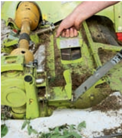
Для ножей предусмотрен снимаемый бокс. Щитки плющилки просто устанавливаются в четырех положениях.
