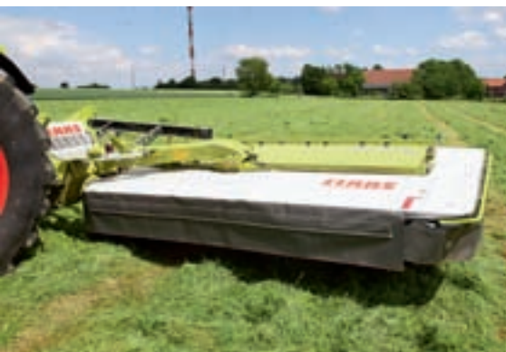
Благодаря устройству защиты, при наезде на препятствие косилки могут отклоняться назад и вверх. Второе отверстие на навеске служит для уменьшения перекрытия с 45 см до 35 см.
