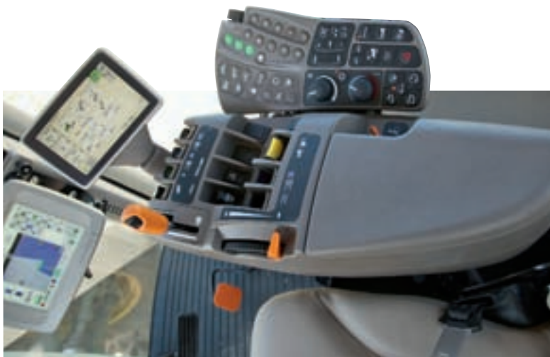
Все элементы управления и наблюдения логично объединены в консоли „CommandArm“ с цветным дисплеем.
