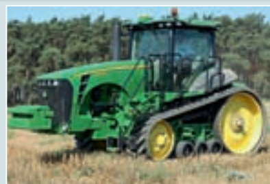
Гусеничное шасси 8RT оснащено системой амортизации и большой поверхностью качения.
