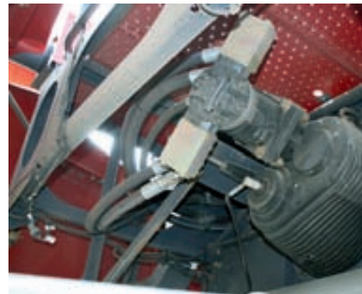
Большой молотильный ротор имеет гидростатический привод с возможностью реверсирования. Трехступенчатый редуктор позволяет регулировать число оборотов в диапазоне от 200 до 1 040 об./мин.
