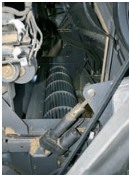
Открытый сверху турбоагрегат обдувает решетчатый стан площадью 5,35 м 2 .
