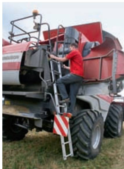
Доступ ко всей машине является очень хорошим. Максимальная мощность двигателя Caterpillar С 13 указывается как 342 кВт/459 л.с. Правда, при размере передних колес 800/65 R 32 ширина машины составляет 3,80 м.
