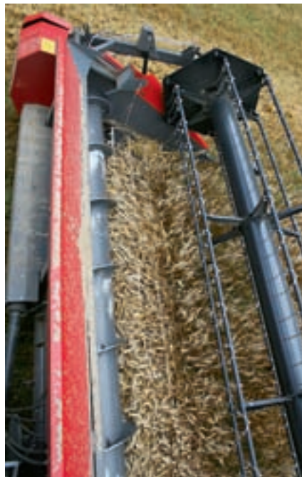
В серийном исполнении комбайн комплектуется зерновой жаткой „Powerflow“ ширины захвата 9,12 м, которая может оборудоваться дополнительным шнеком для уборки рапса.
