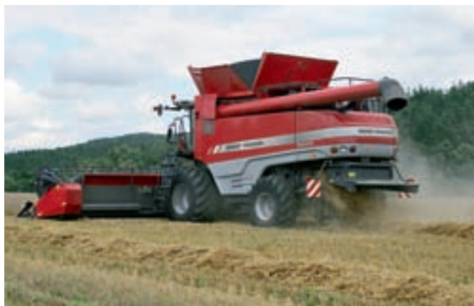
Солома выбрасывается напрямую ротором без дополнительного барабана. Измельчитель соломы от фирмы Rekord имеет восемь рядов ножей и дополнительное устройство для мелкого измельчения, однако, без активного распределения измельченного материала на ширину захвата.
