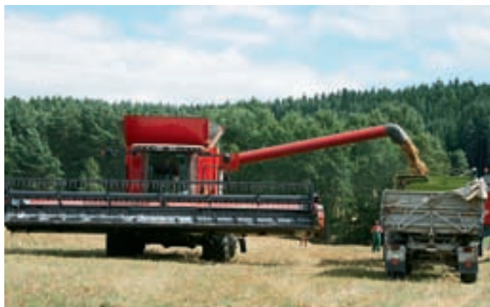
38-сантиметровый шнек проходит с нижней правой стороны в бункере непосредственно к выгрузной трубе. Он отличается очень высокой производительностью выгрузки – более 120 л/сек, но работает только при полностью откинутой трубе.
