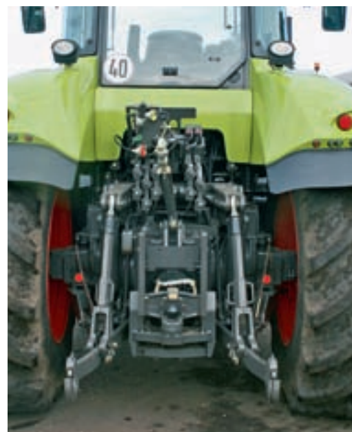
Axion 850 с подъемником со средней величиной подъемной силы (но вполне достаточной) и очень хорошим рабочим ходом.
