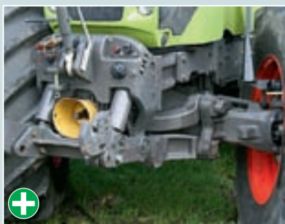
Комплект: внешнее управление подъемником и ВОМ возможно также и спереди.
