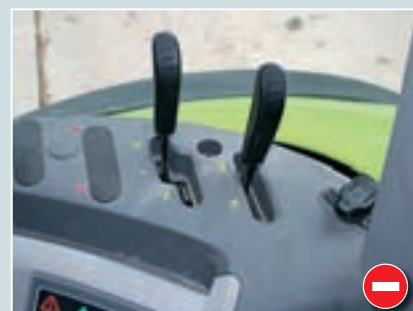
ECO-ВОМ отключается на высоких оборотах.
