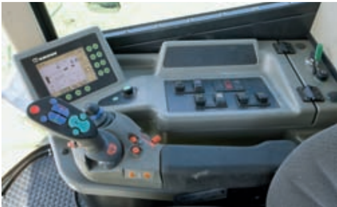
Как и на BiG M 500, справа в кабине находится консоль со встроенным цветным терминалом. Фотографии: Творник.
