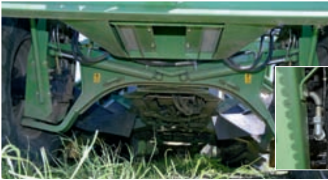
Для большего дорожного просвета задняя ось выгнута, насос гидростата позволяет развивать рабочую скорость движения 20 км/ч.
