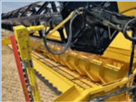
Стол жатки Varifeed выдвигается на 57,5 см, рапсовые делители „паркуются“ на задней стенке зерновой жатки (справа) и могут просто навешиваться сбоку. При этом имеется дополнительная опора к мотовилу.
