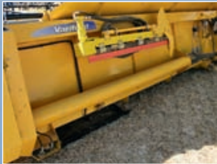
Стол жатки Varifeed выдвигается на 57,5 см, рапсовые делители „паркуются“ на задней стенке зерновой жатки (справа) и могут просто навешиваться сбоку. При этом имеется дополнительная опора к мотовилу.
