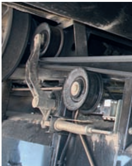
Посредством датчика усилия на нижнем направляющем ролике производится замер нагрузки привода зерновой жатки и наклонного транспортера – для автоматического регулирования рабочей скорости движения.
