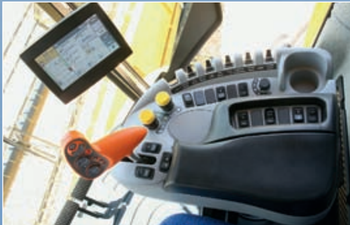
Комфортабельная кабина, включая управление, уже известна; новинкой является сенсорный экран „IntelliView III“.
