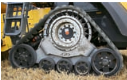
На заказ фирма New Holland готова поставить гусеничное шасси от Tidue с транспортной шириной в пределах 3,50 м.
