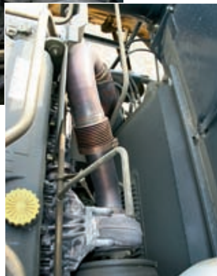
Серийный двигатель комбайна CR 9090 Elevation максимальной мощностью 591 л.с. (вверху) оснащается тягой с соплами, во избежание пожара к которым регулярно подается сжатый воздух (внизу).
