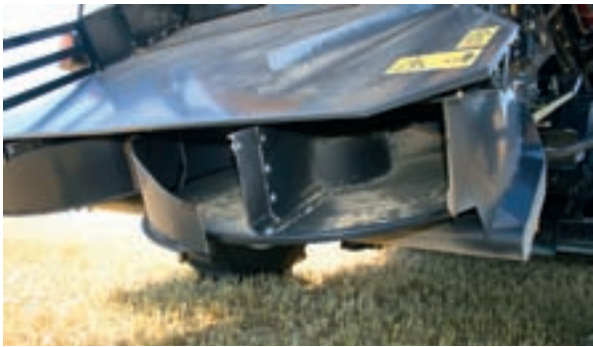
Система активного распределения соломы состоит из двух разбрасывающих дисков с гидравлическим приводом, а также двух регулируемых щитков-дефлекторов.
