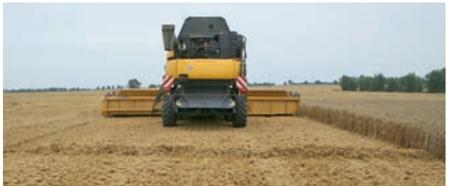
Если пожнивные остатки необходимо сгрести в поперечный валок, действительно хорошее распределение соломы на ширину захвата более 10 м становится еще заметнее.
