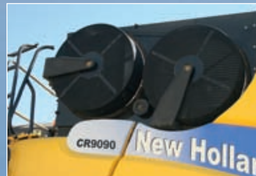
Чтобы „облегчить дыхание“ нового двигателя Cursor-13 мощностью до 591 л.с. перед радиаторами установлены две вращающиеся сетки.
