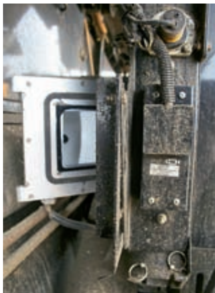
Для определения доли битого зерна и отображения результатов на терминале, внутрь зернового элеватора помещена камера „GrainCam“ (здесь – открыто).
