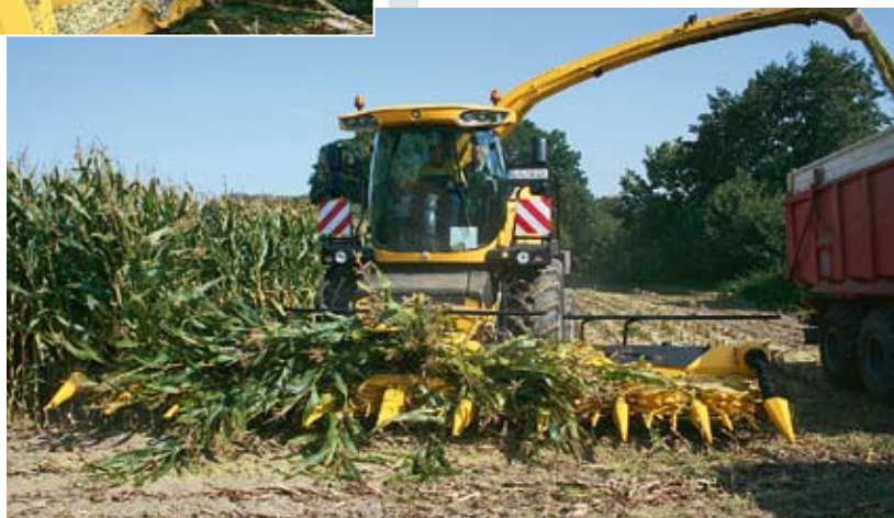
Десятирядная жатка 470FIE производства Кетрег в наших условиях работы показала себя хорошо, несмотря на случившиеся порой забивания (слева). В сравнении с восьмьюрядной жаткой она, несомненно, является более подходящей рабочей приставкой для комбайна FR9060.
