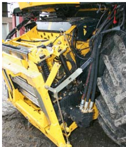
Отдельный привод для рабочей приставки с дополнительным гидромотором на левой стороне позволяют выполнить настройку числа оборотов приставки.
