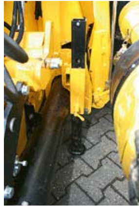
Ширина подающего канала жатки 470FIE (пока еще) далеко не оптимально согласована с шириной измельчающего аппарата комбайна. Стопорное устройство опорной стойки на жатке (справа) может быть захвачено стеблями кукурузы.
