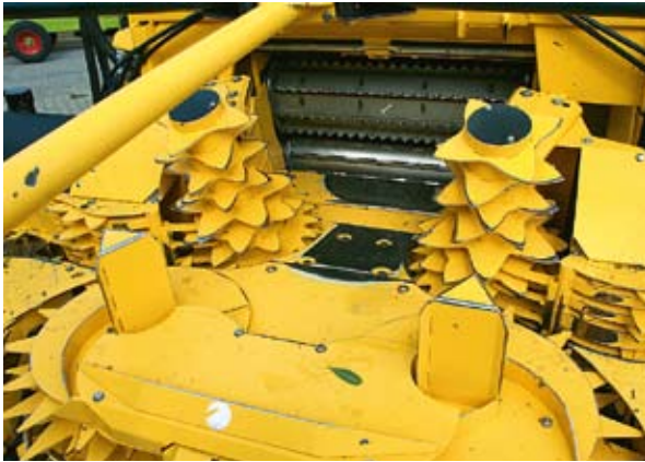
Ширина подающего канала жатки 470FIE (пока еще) далеко не оптимально согласована с шириной измельчающего аппарата комбайна. Стопорное устройство опорной стойки на жатке (справа) может быть захвачено стеблями кукурузы.
