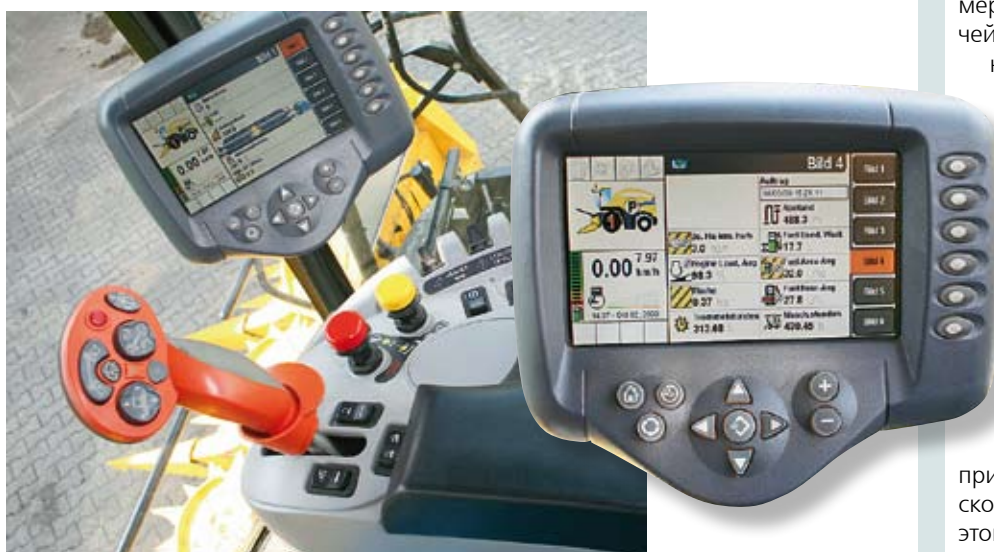
Центр управления отвечает любым пожеланиям, все расположено очень наглядно и продуманно. Правую сторону монитора, состоящего из шести частей, можно запрограммировать индивидуально. На левой стороне всегда видны уровень топлива и температура двигателя.
