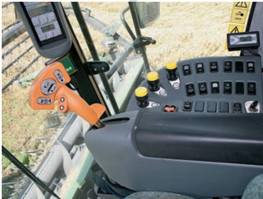
Джойстик и консоль управления – хорошие, но с тремя выключателями одинаковой формы – для зерновой жатки, молотильного аппарата и разгрузки зернового бункера – мы не раз запутались.
