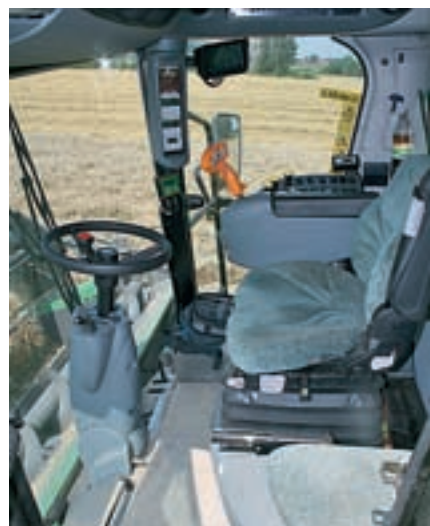
Кабина комбайна 6300 С весьма просторна, если не считать низкой крыши. Уровень шума в 82 дБ(А) не соответствует веяниям времени.
