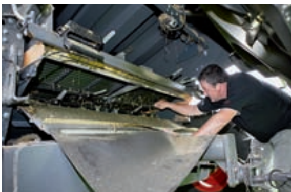
Доступ к решетам неудобный, электрическая регулировка не предусмотрена. Сетка над датчиком потерь зерна постоянно забивается длинной соломой.
