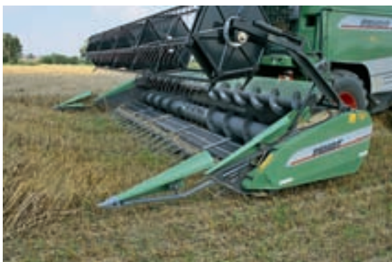
Жатка „Power-Flow“ с шириной захвата 6,75 м показала хороший результат; дополнительный шнек предназначается, прежде всего, для рапса.
