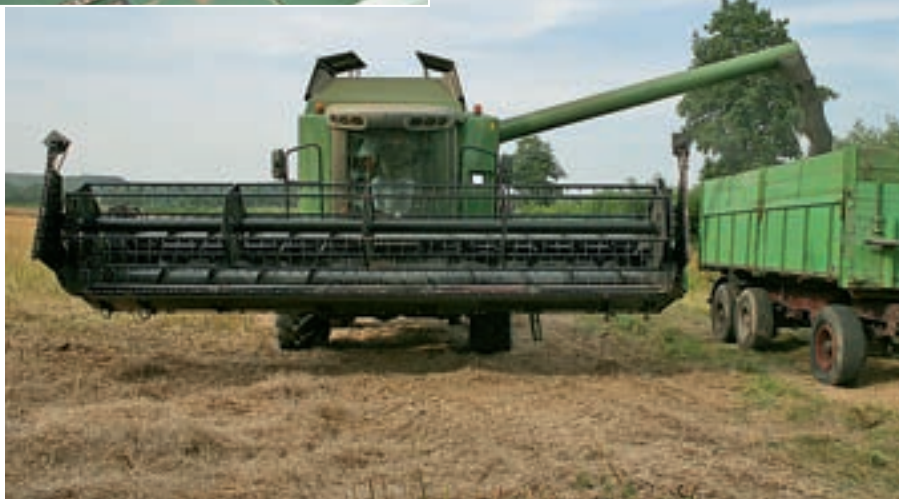
Высота и дальность верхней выгрузки были хорошими. В зерновом бункере помещалось 6,4 тонн пшеницы, разгрузка длилась 100 секунд.
