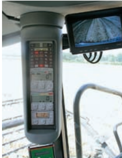
Держатель удобного для работы монитора закреплен на крыше кабины.
