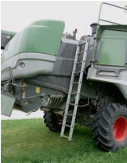
Доступ является хорошим, топливный бак вмещает теперь 600 л вместо прежних 450 л. Для измельчения соломы надо просто переставить щиток.
