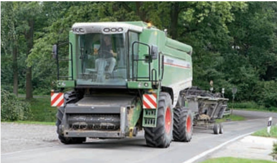
Для того, чтобы ширина оставалась в пределах 3,50 м, размер шин не должен быть больше 650-го размера. При нагрузке на переднюю ось более 18,5 т на влажном поле (с зерновой жаткой и полным зерновым бункером) этого может оказаться недостаточно.
