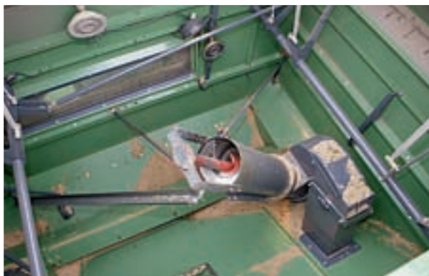
Высота и дальность верхней выгрузки были хорошими. В зерновом бункере помещалось 6,4 тонн пшеницы, разгрузка длилась 100 секунд.
