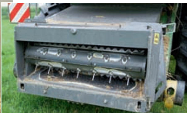
Особенностью является дополнительный барабан перед наклонной камерой.
