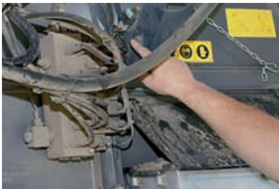
Деку под центробежным сепаратором можно легко откинуть с помощью электродвигателя – замечательная вещь, позволяющая реагировать на самые разные условия работы.
