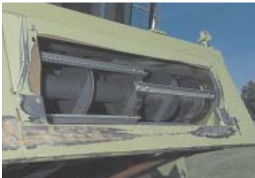
Передний направляющий валец на элеваторе наклонной камеры оснащён двумя поддерживающими дисками
