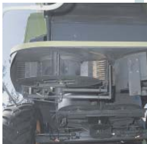
Радиальный распределитель включает в себя два разбрасывающих ротора с двумя направляющими планками между ними.
