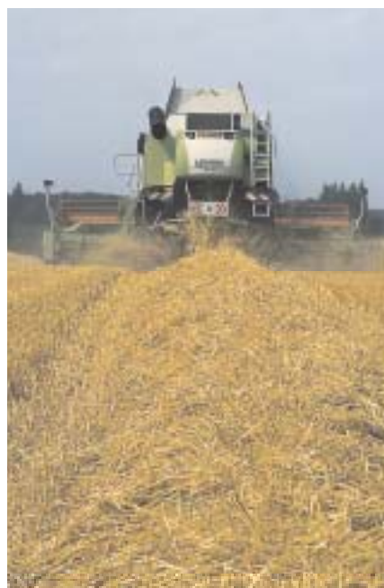
Структура соломы после роторов оптимальная, хотя валок слишком узкий.
