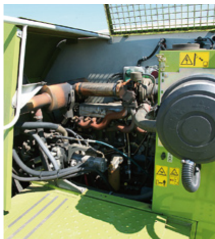
Der Caterpillar C 6.6 leistet fast 200 PS und sitzt hinter dem Korntank.
