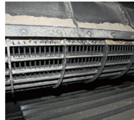
Der Aufbau von Rotor und Korb ist vergleichbar mit den Doppelrotoren im Lexion. Der Antrieb erfolgt mechanisch von der linken Seite.
