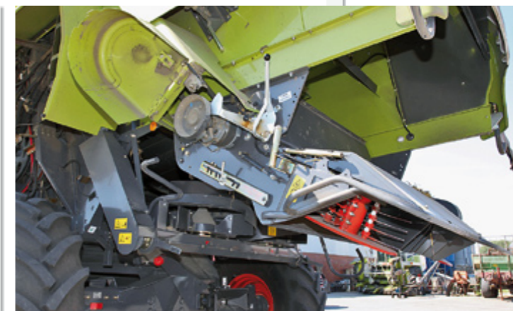
Der Häcksler hat jetzt 80 Messer und eine mechanische Kupplung im Antrieb. Er kann auf Wunsch mit den zwei Wurfrotoren („Active Spreader“) ausgerüstet werden. Der neue HD-Spreurverteiler soll verschleißfester sein und muss für Mais nicht mehr umgebaut werden.
