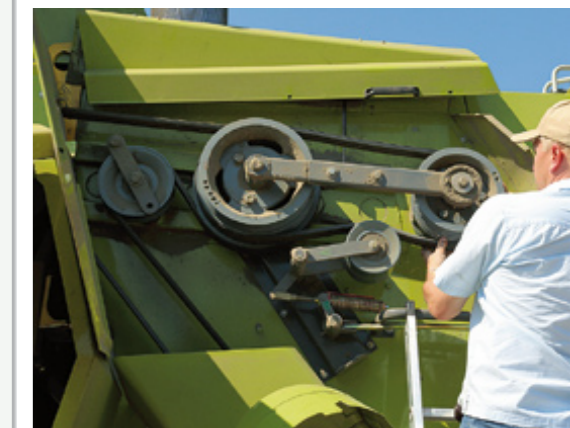
Die Drehzahl des Rotors kann durch Umlegen des Keilriemens verstellbar werden.
