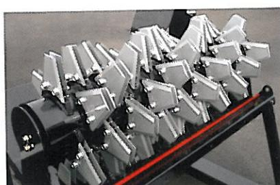
Многоступенчатый обмолот растительного материала на комбайнах Case IH является более мягким с минимальным повреждением зерна. Охват подбарабаний увеличен на 30%, благодаря применению в комбайнах Case 20-й серии модульной системы подбарабаний.
