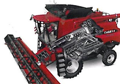
Весь процесс обмолота обеспечивается многократным перемещением растительной массы через подбарабанье посредством мягкого трения, сепарация оставшегося зерна – по мере спирального перемещения пожнивных остатков в заднюю часть ротора.
