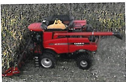
На комбайнах Case 20-й серии установлен измельчитель нового образца с возможностью регулировки интенсивности измельчения. Обеспечивается равномерное распределение пожнивных остатков и половы по всей ширине среза.
