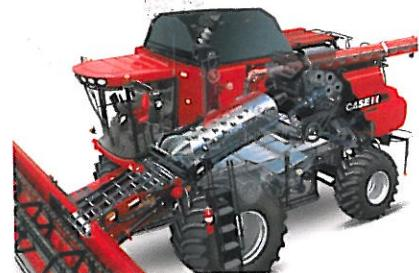
Конструкция бункеров комбайнов 20-й серии емкостью до 12 300 л обеспечивает равномерную загрузку при работе на полях с уклоном. Выгрузной шnek с электрогидравлическим приводом позволяет разгрузить бункер за 113 секунд.
