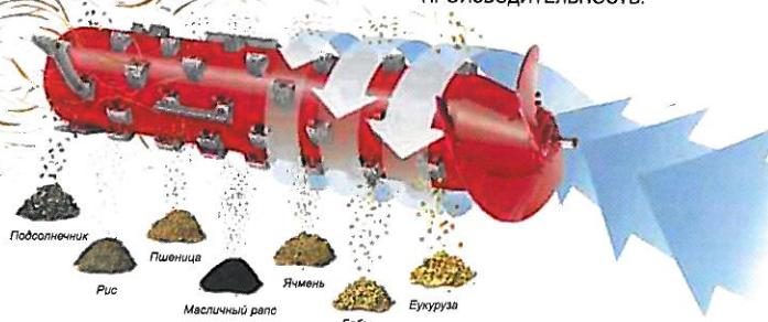
Подбарабанье сепаратора охватывает ротор в зоне обмолота на 156 градусов, в зоне сепарации остаточного зерна - на 133 градуса, что обеспечивает общую площадь обмолота и сепарации - 2,8 м<sup>2</sup>. Комбайны оборудованы трехступенчатой системой очистки общей площадью 5,48 м<sup>2</sup>.
