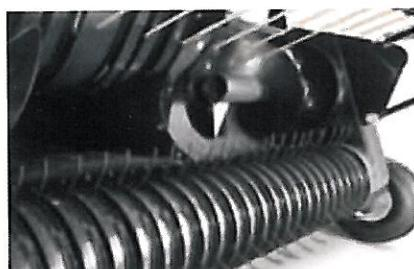
Прессы Case серии LB вмещают в себя до шести тяжелых функциональных узловязальных машин (в зависимости от модели), созданных для качественной упаковки тюков. Мощные железные лопасти предохраняют узловязатели от пыли и соломы.
