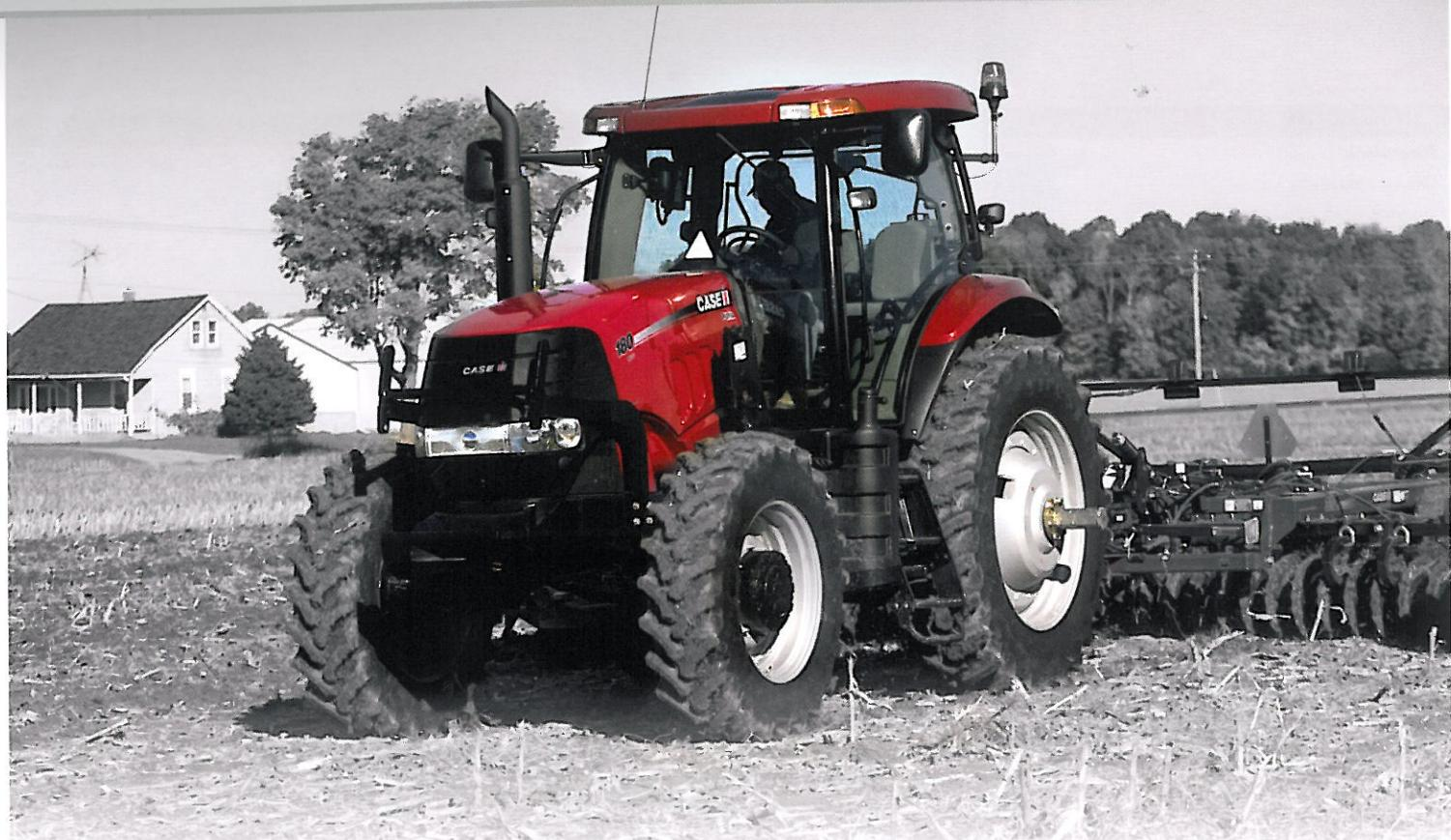
Трактор серии Puma оснащен 24 клапанным 4-х цилиндровым двигателем Case IH, объемом 6,75 л. мощностью до 223 л/с., прекрасно зарекомендовавших себя на современных тракторах.
