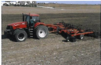
Использование спаренных шин (поставляется в комплекте) позволяет увеличить коэффициент динамического трения на 20% по сравнению с одинарными колесами и снизить давление на грунт и уменьшить пробуксовку.
