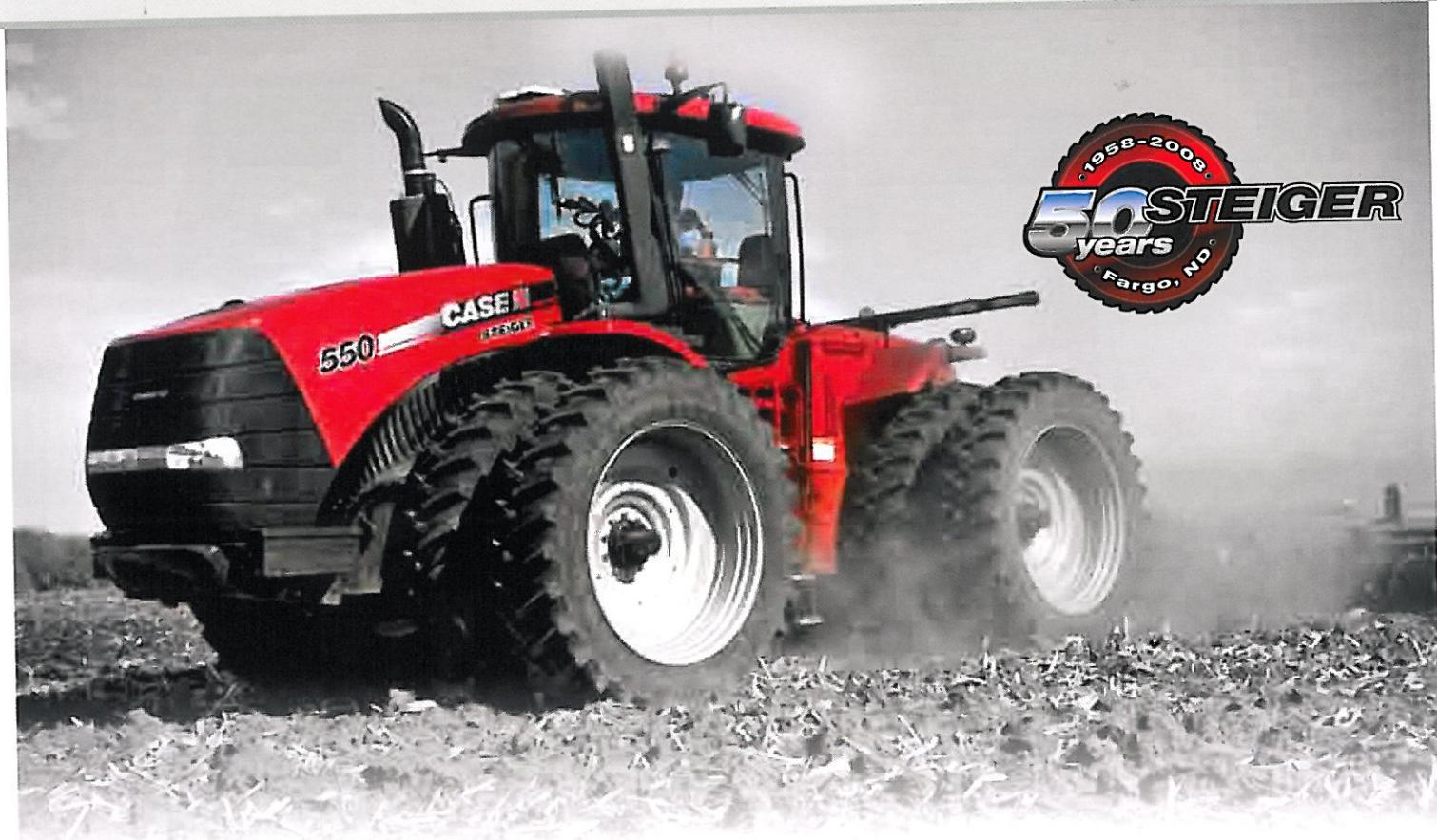
Трактора серии Steiger приводятся в движение новыми, более экономичными 12,9 л. двигателями Iveco, мощностью до 660 л.с.
