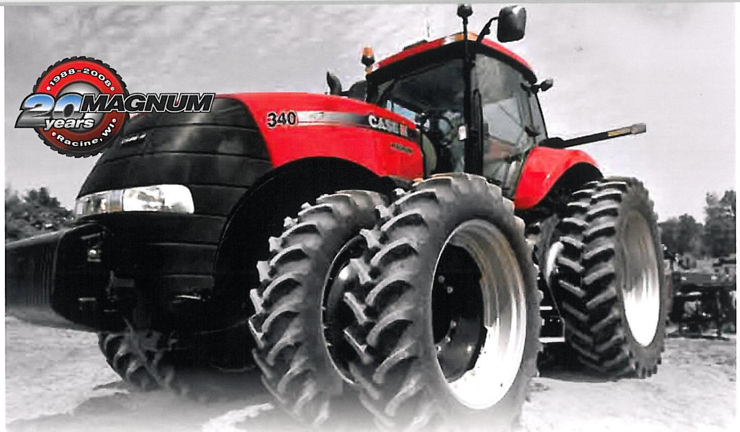
Все модели новой серии оборудованы более экономичными 6-ти цилиндровыми двигателями Iveco мощностью до 390 л.с., которые успешно зарекомендовали себя на комбайнах премиум класса Case 8120. Применение 4-х клапанов на цилиндр, позволяет оптимизировать процесс сгорания топлива в широком диапазоне режимов работы двигателя.
