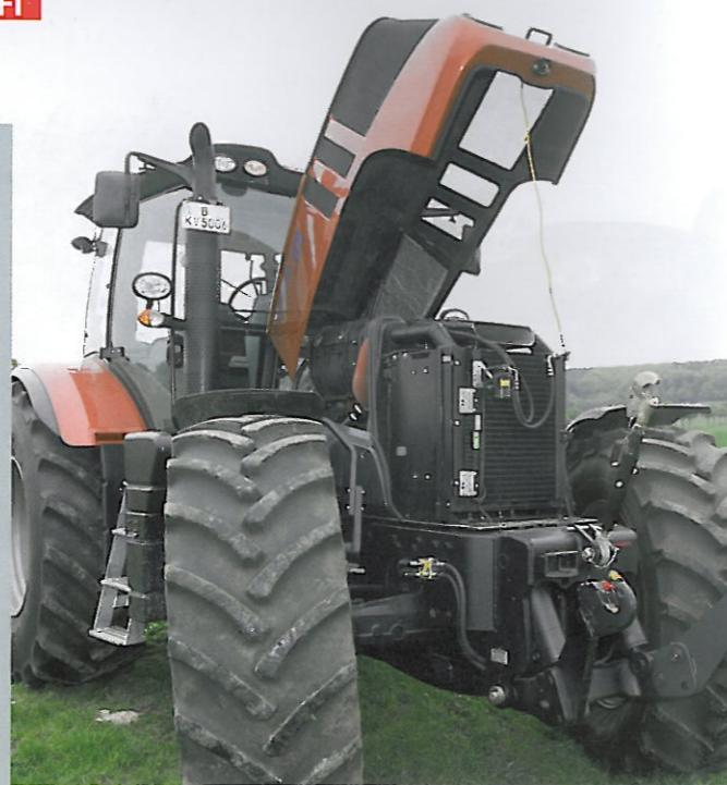
Под большим цельным капотом работает шестицилиндровый двигатель фирмы Deutz объемом 7,2 л. Потребление топлива среднее, показатели мощности могли бы быть лучше.
