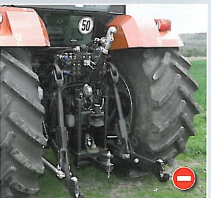
Только для двух распределительных клапанов сзади на блоке клапанов предусмотрена механическая настройка пропускаемого количества масла. Управление временем подачи не предусмотрено даже опционально.
