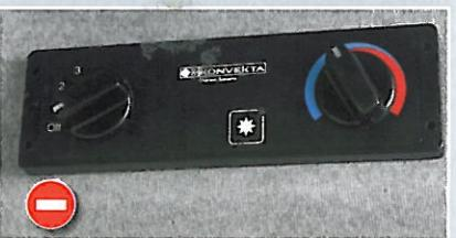
Вентилятор имеет лишь 3 степени обдувания. Его мощность также могла бы быть выше.
