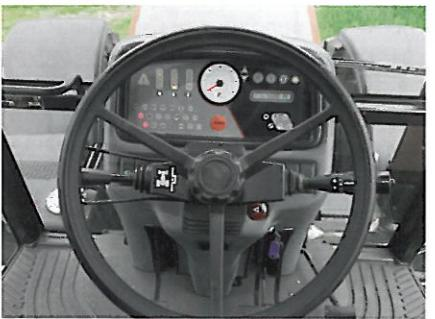
Реверсивный переключатель слева и рычаг поворотника справа – в порядке. Только при ярком солнечном свете показания на панели почти не видны, а переключение показателя скорости и числа оборотов вручную задает работу.
