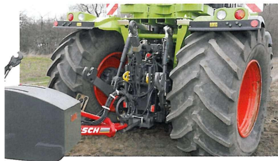
Das gewaltige Heckhubwerk der Kat. IV N hebt 13,6t und kostet rund 10000 Euro extra. Hinten gibt es bis zu sechs Steuerventile - natürlich alle mit Zeit- und Mengensteuerung.
