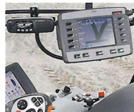
Das „Cebis Mobile“ ist ISO-fähig. Hier wird auch das neue GPS-Lenkensystem (in Zukunft auch mit RTKnet) bedient.
