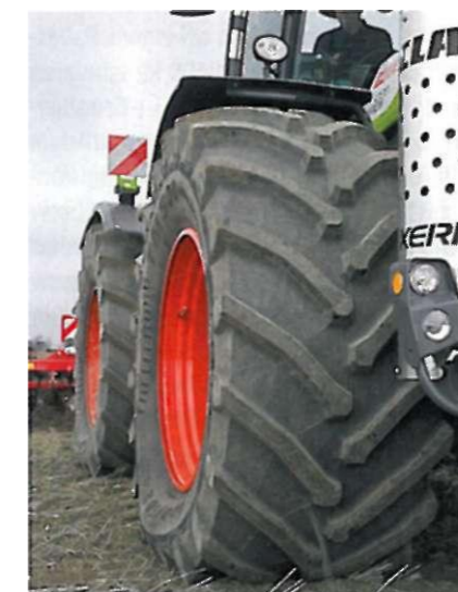
Die 2,16 m hohen Räder der Größe 900/60 R 42 können bei 211 Gesamtgewicht mit 1 bar gefahren werden. Der Xerion 5000 ist damit 3,29 m breit.
