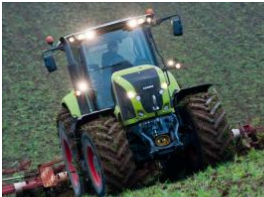
Bis zu 20 Scheinwerfer ermöglichen eine 360-Grad-Ausleuchtung. © CLAAS
