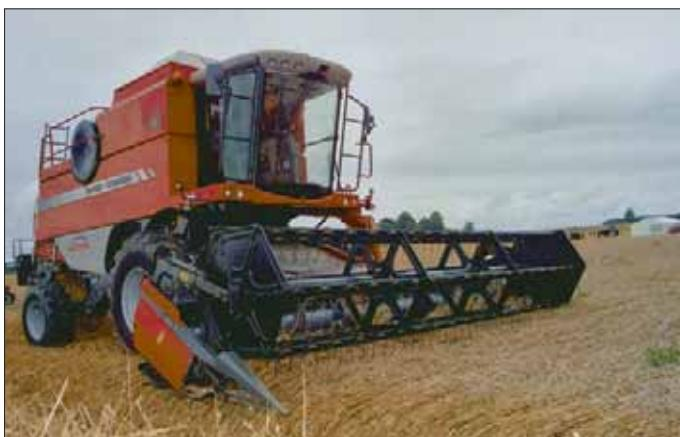
MF 7245 «Актива» с пятиметровой жаткой. Система Autolevel компенсирует поперечный и продольный наклон комбайна.
