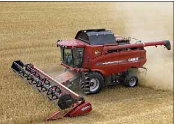
**Роторный комбайн AF 8010 «Кейс ИН» в работе. Новая концепция ротора с безрежимным приводом и бесступенчатой регулировкой частоты вращения обеспечивает высокую производительность и качество обмолота.**
