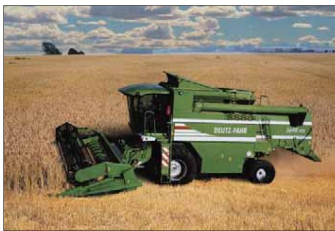
Высокопроизводительный комбайн серии 56 «Дойц-Фар» с системой компенсации наклона BALANCE
