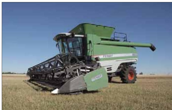
Новый роторный комбайн 9460 R фирмы «Фендт». Электроника CAN-Bus позволяет осуществлять контроль за работой машины.
