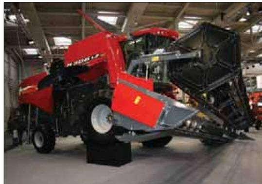
**Новая модель комбайна M 306 LS** фирмы «Лаверда» была представлена на выставке «Агритехника 2007». Машина оснащена системой компенсации наклона (поперек – до 20 %, вдоль – до 30 %).
