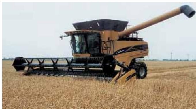
**Высокопроизводительный роторный комбайн CH 680B** фирмы «Челленджер» выпускается для крупных хозяйств и агросервисных предприятий. По конструкции он идентичен комбайну MF 9895 фирмы «Массей Фергусон».
