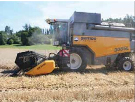
**Новый комбайн ««Сампо» серии SR 3085L. Эта серия также оснащена четвертым сепарирующим барабаном CSP, позволяющим значительно повысить производительность на уборке!**
