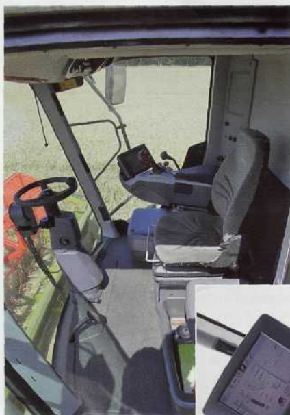
Кабина очень просторная, а с большим цветным дисплеем Cebis водитель держит весь процесс работы под контролем.
