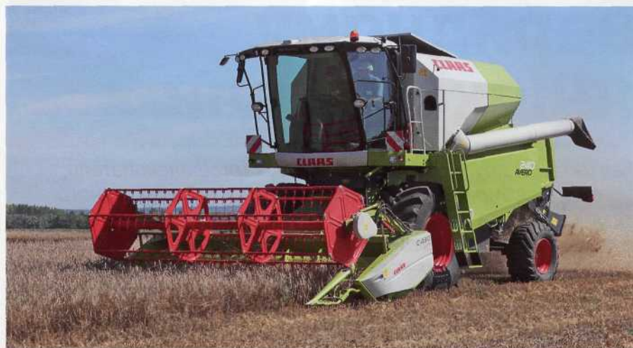
Новый Claas Avero с четырехклавишным соломотрясом и системой APS в сравнении можно расположить между Dominator 150 и Tiscano 320. Снимок: Г. А.
