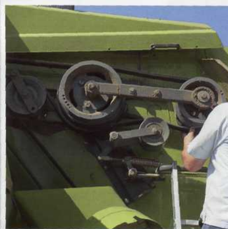
Скорость вращения ротора изменяется при помощи перекладки клиновых ремней.
