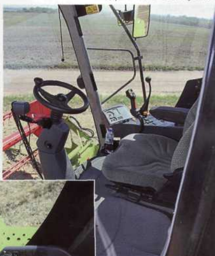
Рычаг хода – отличный, но (пока) отсутствует автоматическая регулировка высоты среза и счетчик гектаров.
