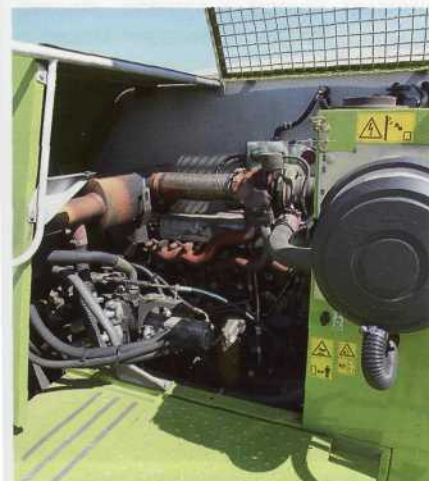
Мотор Caterpillar С6.6 выдает почти 200 л.с. и расположен за зерновым бункером.
