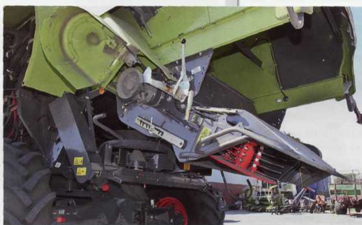
Устройство ротора и деки сравнимо с двойным ротором на Lexion. Привод осуществляется механически с левой стороны.
