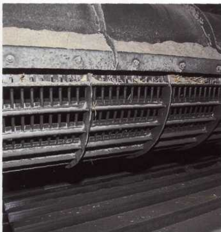
Устройство ротора и деки сравнимо с двойным ротором на Lexion. Привод осуществляется механически с левой стороны.
