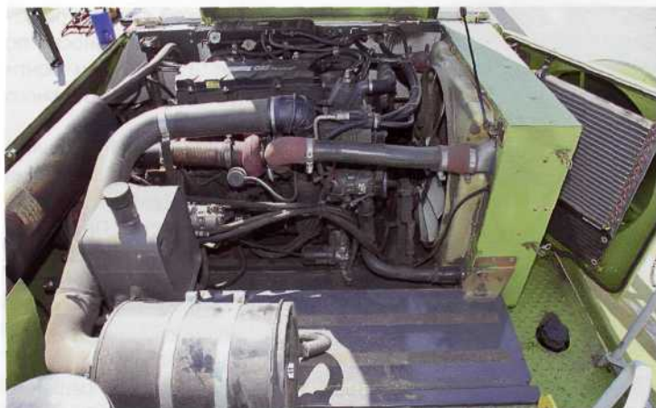
Мотор Caterpillar C9 имеет объем 8,8 л и выдает максимум 269 кВт/365 л.с.
