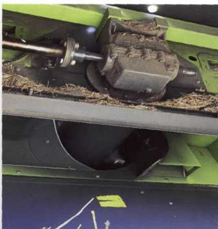
Устройство ротора и деки сравнимо с двойным ротором на Lexion. Привод осуществляется механически с левой стороны.
