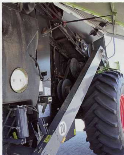
Привод реверсивного барабана у двухступенчатого вариатора расположен за вариатором молотильного барабана и регулируется синхронно. С дополнительным топливным баком общий запас топлива составляет 750 л.
