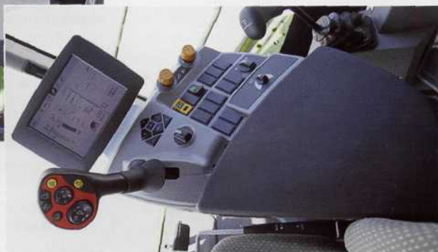
Кабина очень просторная, а с большим цветным дисплеем Cebis водитель держит весь процесс работы под контролем.
