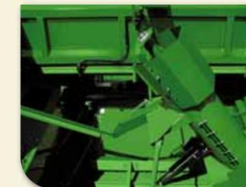
Die zentrale Korntank-Befüllschnecke schwenkt automatisch nach oben. Der Korntank wird vollständig befüllt.
