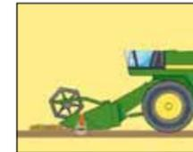
**Positionstaste 1 – Höhenrückführung:** Das Schneidwerk kehrt in eine vorgewählte Höhe zurück, zum Beispiel beim Ausheben am Vorgewende oder bei langen Stoppeln (Raps, Mais).
