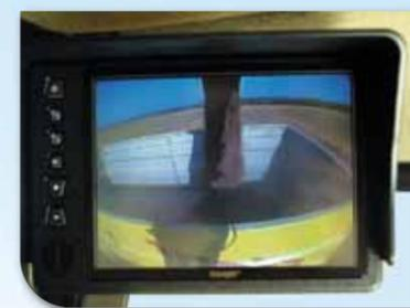
Mit Außenkameras und Farbmonitor in der Kabine als Wahlausrüstung haben Sie die Stroh- und Spreuerverteilung oder Ihren Schneidwerkswagen immer im Bilde. Zum Abtanken schalten Sie die Kamera am Entleerrohr ein.
