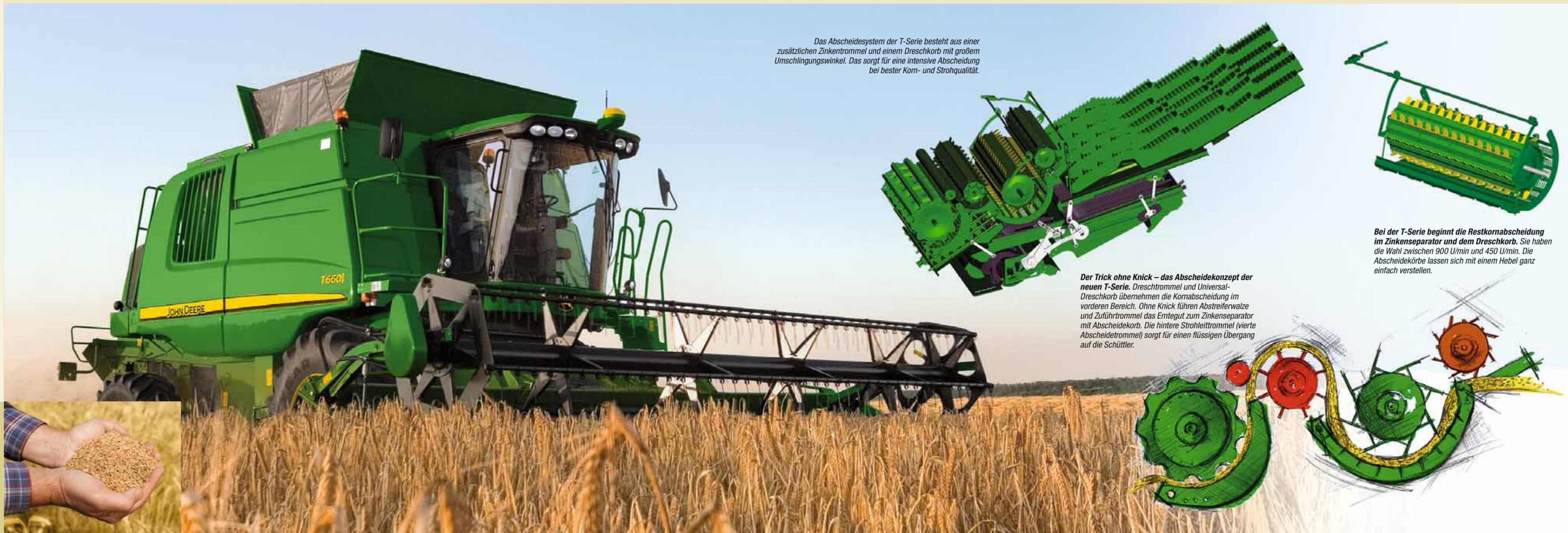
Das Abscheidesystem der T-Serie besteht aus einer zusätzlichen Zinkentrommel und einem Dreschkorb mit großem Umschlingungswinkel. Das sorgt für eine intensive Abscheidung bei bester Korn- und Strohqualität.
