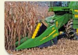
**Die CornStar Maispflücker** machen die Maisernte erfolgreicher. Das innovative rotierende Einzugsystem sorgt für eine schnelle und gleichmäßige Zuführung. Das Einzugsystem ohne Ketten minimiert die Wartung und den Verschleiß. Das prämierte System erlaubt reihentolerantes Ernten und lässt sich zum Transport auf 3,30 m einklappen. Sie haben die Wahl zwischen dem 6- und 8-reihigen Modell.
