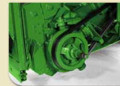
**Reversieren aus der Kabine.** Das Reversiergetriebe löst schwerste Verstopfungen per Tastendruck, gleichzeitig dreht die Haspel rückwärts. Das ist Produktivität pur!
