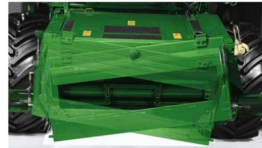
Das Pendelschild kann um 9 Grad in der Neigung und um 4 Grad seitlich verstellt werden. Das Ergebnis: Gleichmäßige Stoppelhöhe und beste Bodenpassung auch bei stark wechselnden Bedingungen.
