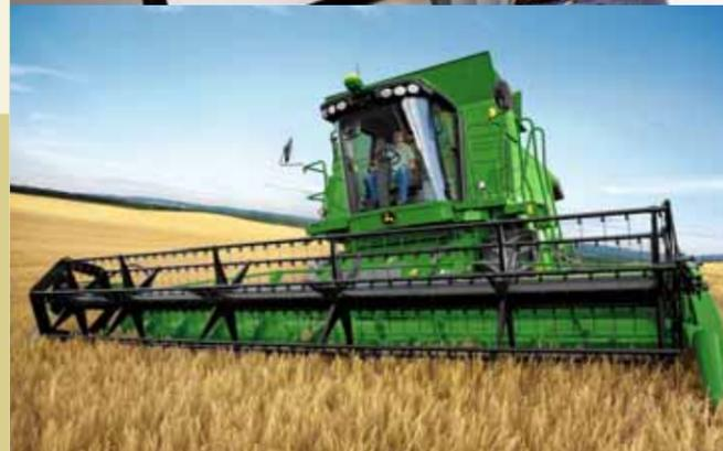
**AME – Mit der automatischen Mähdreschereinstellung** können Sie die Leistung Ihres Mähdreschers ganz einfach an die Erntebedingungen anpassen. AME bietet zudem die Möglichkeit, die Sieböffnung automatisch einzustellen. Bei der elektrischen Siebverstellung sind Stellmotoren direkt am Sieb montiert. Das sichert hohe Präzision.
