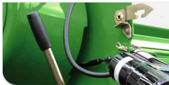
Einfacher geht's nicht: Das Leitblech lässt sich mit einem Hebel in der Höhe verstellen.
