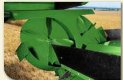
Der unabhängig angetriebene, hydraulische Spreuverteiler verteilt die Spreu über die gesamte Schneidwerksbreite und kann auch bei der Schwadablage verwendet werden.
