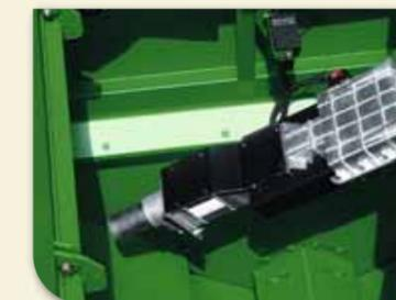
Der Feuchtesensor im Korntank zeigt Ihnen schnell und präzise den Feuchtegehalt an.
