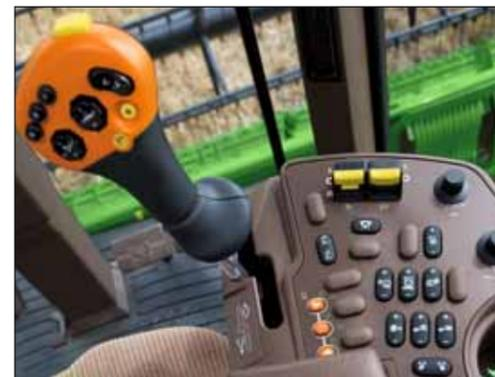
Die **logisch und griffgünstig angeordneten Bedienelemente** sind intuitiv zu bedienen. Mit den „SoftTouch“-Tasten wird die Feinabstimmung der Leistung Ihres Mähdeschers zum Kinderspiel. Dreschtrommel- und Gebläsedrehzahl sowie Korbabstand lassen sich mit den Fingerspitzen ganz präzise einstellen. Dazu können Sie die Konsole in der Armlehne einfach und bequem in Höhe und Längsrichtung verstellen.
