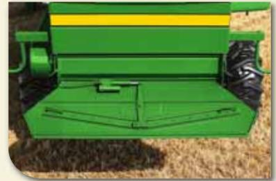
Die Strohleitbleche werden manuell mit einem einzigen Hebel verstellt. Auf Wunsch erhalten Sie auch ein elektrisch verstellbares System (wie beim Premiumhäcksler).
