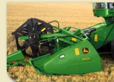
Der flache Winkel der Gutzuführung vom langen Schrägförderer sorgt für einen gleichmäßigen Gutfluss zur Dreschtrommel ohne Ecken und Kanten.
