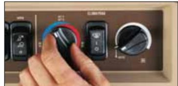
Die Klimaautomatik **ClimaTrak** hält die Kabinentemperatur automatisch konstant.
