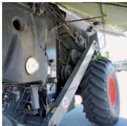
Auch der Antrieb der Wendetrommel sitzt beim 2-Stufen-Regeltrieb jetzt hinter dem Trommelvariator und wird synchron verstellt. Mit Zusatztank hat man 750 l Diesel an Bord.
