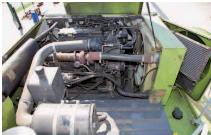
Der Caterpillar C 9 hat 8,8 l Hubraum und leistet maximal 269 kW/365 PS.
