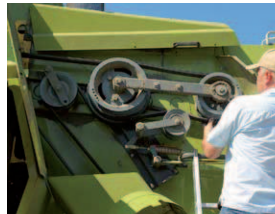
Die Drehzahl des Rotors kann durch Umlegen des Keilriemens verstellt werden.
