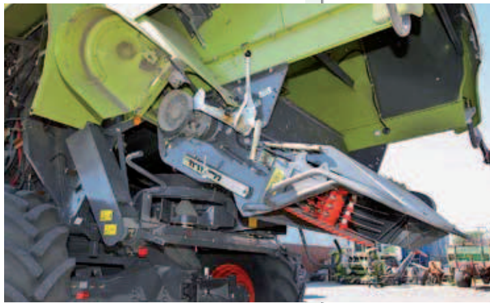
Der Häcksler hat jetzt 80 Messer und eine mechanische Kupplung im Antrieb. Er kann auf Wunsch mit den zwei Wurfrotoren („Active Spreader“) ausgerüstet werden. Der neue HD-Spreuverteiler soll verschleißfester sein und muss für Mais nicht mehr umgebaut werden.
