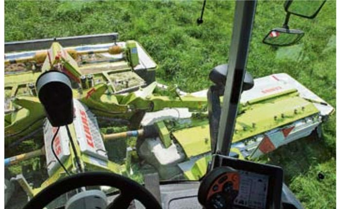
*...und die Sicht auf die Mäheinheiten ist hervorragend. Bedient werden die Mähwerke über die Funktionstasten auf dem Fahrhebel des Xerion.*
