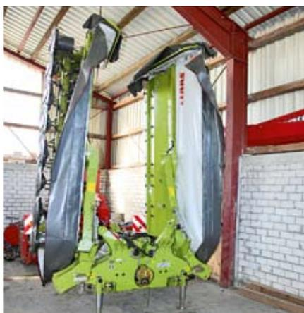
Die Stützen sind praktisch und stabil. So kann der Mäher platzsparend abgestellt werden. Es fehlt auch kein Gelenkwellenhalter, und die Ölschläuche sind ordentlich markiert – super!
