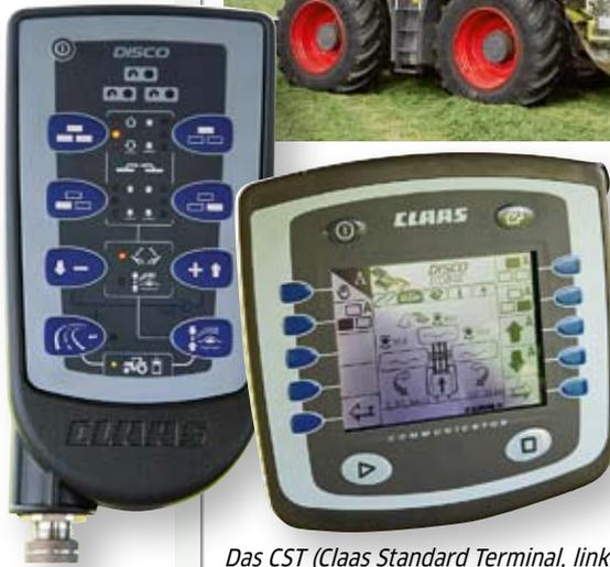
Das CST (Claas Standard Terminal, links) hat alle Funktionen. Bei der Ausstattung mit dem Communicator (rechts) kann man zusätzlich Aufträge anlegen, die tatsächlichen Drehzahlen der Mähwerke werden angezeigt, und die (Vorgewende-)Aushubhöhe ist einstellbar.
