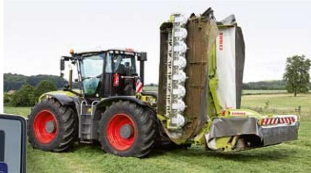
Die Umrüstung Straße / Feld dauert bei beiden Varianten weniger als eine Minute. Dank hydraulisch geklappter Schutztücher muss man nicht mal absteigen.
