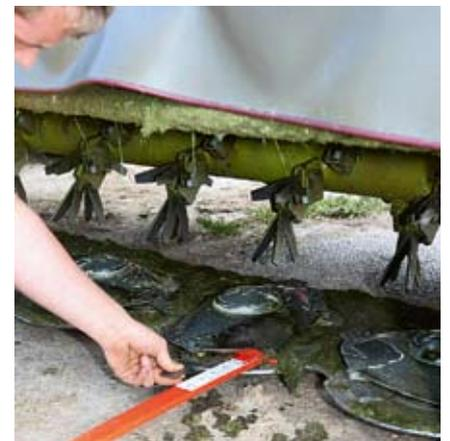
Der Klingenwechsel ist bei halbwegs sauberen Mähtellern einfach. Dank hoher Umfangsgeschwindigkeit kann man auch mit reduzierter Zapfwelldrehzahl arbeiten.
