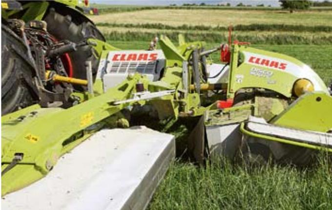
*In Schubfahrt wird auch beim Frontmähwerk der Auflagedruck über die Hydraulikzylinder mit dem „ActiveFloat“-System gesteuert,...*
