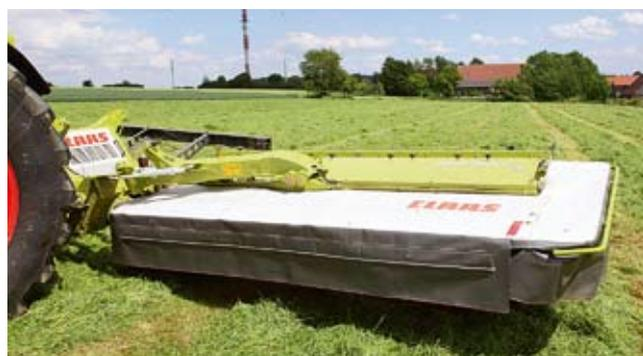
Dank Anfahrtsicherung kann der Mäher nach hinten und oben ausweichen. Mit der zweiten Bohrung in der Aufhängung kann die Überlappung von 45 auf 35 cm reduziert werden.
