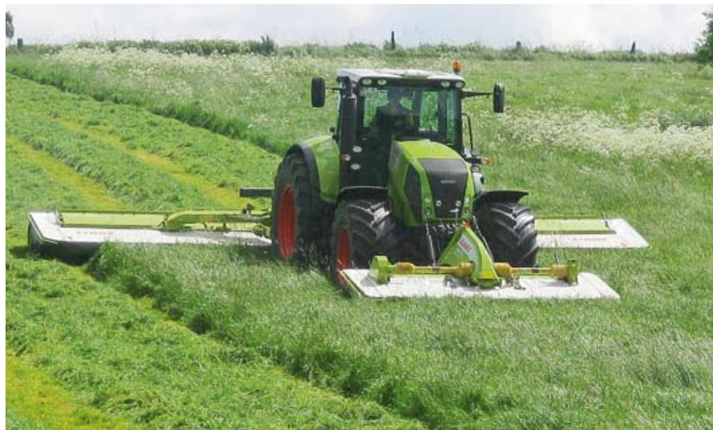
Das Ausheben des Mähwerkes muss mit dem Fronthubwerk erfolgen. Doch dank der „DUO“-Doppelbedienung ist das zusammen mit einem Vorgewende-Management (z. B. CSM beim Claas Axion) kein Problem.
