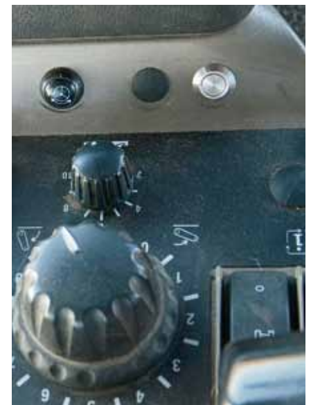
Über den kleinen silbernen Knopf in der Bedienarmlehne aktivieren wir beim Case IH Magnum 280 den GPS Pilot.
