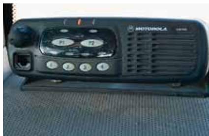
Das Funkgerät wird gebraucht, um das RTK-Signal von der nächsten Feststation zu empfangen, die z. B. ein Claas-Händler installiert hat. Ein leises, in kurzen Abständen ertöndendes Rauschen signalisiert den Datenempfang.
