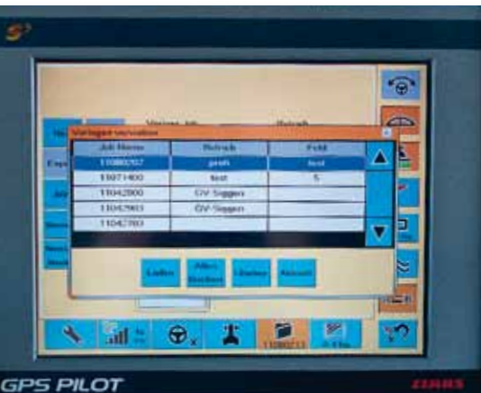
Alte Referenzspuren und Feldgrenzen speichert der GPS Pilot, so dass sie jederzeit wieder verwendbar sind. Auch ein Import von Linien und Grenzen sowie von Aufträgen ist möglich.
