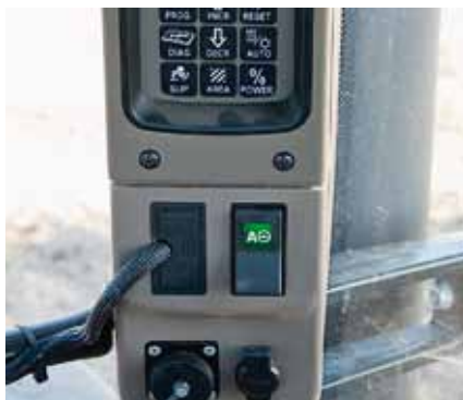
Den Schalter in der A-Säule schreibt der TÜV vor. Bei Straßenfahrt darf der GPS Pilot keine Befehle an die Lenkventile senden. Deshalb muss an dieser Stelle die Stromversorgung zu den Ventilen unterbrochen und die automatische Lenkung damit zuverlässig deaktiviert werden.
