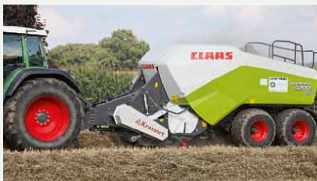
Trotz Vorbauhäcksler fährt Lohnunternehmer Meyer mit vollem Messersatz in der Presse, um Überlängen bei dem Stroh für die Einstreu so weit wie möglich zu reduzieren.
