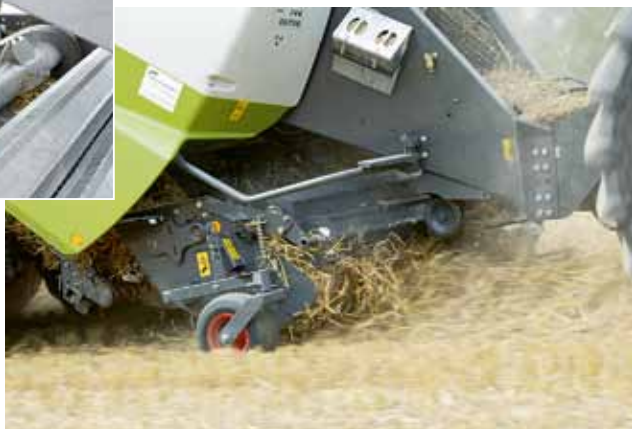
Die gesteuerte Pickup mit vier Zinkenreihen und der zusätzlichen Förderwalze vor dem Rotor schluckt alles und arbeitet auch bei 25 km/h noch sauber. Nur 1,90 m Rechbreite sind bei großen Schwaden knapp.
