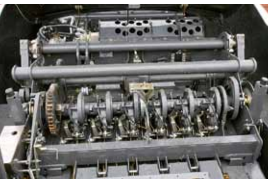
Die sechs Einfachknoter werden von dem „Turbo-Fan“ vorne sauber gehalten und arbeiten sehr zuverlässig. Die Zentralschmierung ist serienmäßig.
