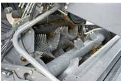
Die gesteuerte Pickup mit vier Zinkenreihen und der zusätzlichen Förderwalze vor dem Rotor schluckt alles und arbeitet auch bei 25 km/h noch sauber. Nur 1,90 m Rechbreite sind bei großen Schwaden knapp.
