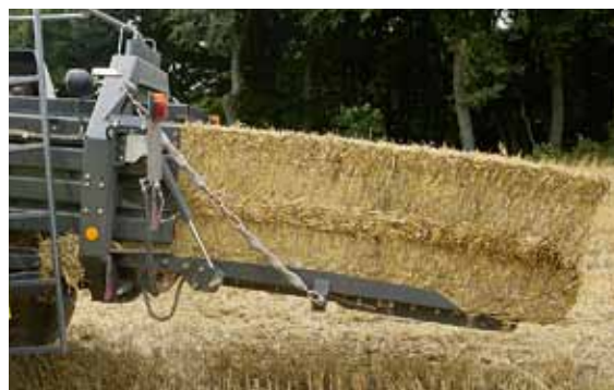
Ballenform und -dichte waren gut. Dank des Drei-Wege-Hahns und der Tasten (rechtes Bild) kann man die Schurre klappen oder den Ballenausstoßer bedienen. Dabei wird der Presskanal automatisch entlastet.
