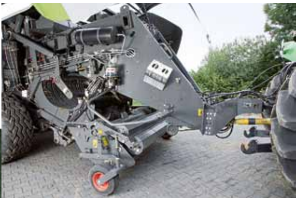
Die gesteuerte Pickup mit vier Zinkenreihen und der zusätzlichen Förderwalze vor dem Rotor schluckt alles und arbeitet auch bei 25 km/h noch sauber. Nur 1,90 m Rechbreite sind bei großen Schwaden knapp.
