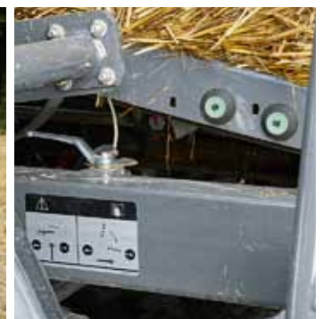
Ballenform und -dichte waren gut. Dank des Drei-Wege-Hahns und der Tasten (rechtes Bild) kann man die Schurre klappen oder den Ballenausstoßer bedienen. Dabei wird der Presskanal automatisch entlastet.
