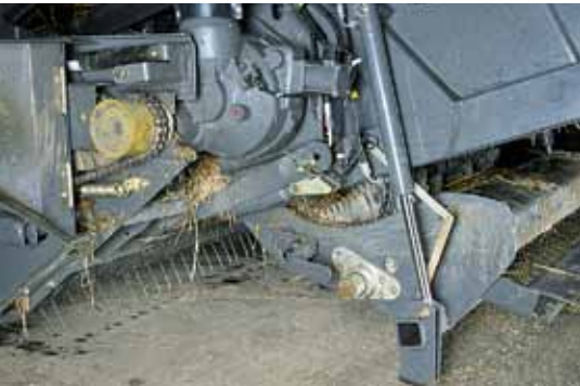
Die Kugelschaltkupplung vom Rotor wird sofort deaktiviert, wenn die Nockenschaltkupplung des Raffers anspricht. Die Schneidmulde senkt sich bei einer Blockade ebenfalls automatisch ab.
