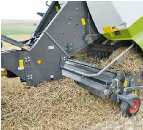
Die Deichsel ist für eine bessere Sicht etwas länger geworden. Die 2,35 m breite Pickup stammt von der großen Quadrant 3400. Sie hat auch die hydraulische Entlastung, wird aber nicht hydraulisch, sondern mechanisch samt Nockenschaltkupplung (rechtes Bild) angetrieben.
