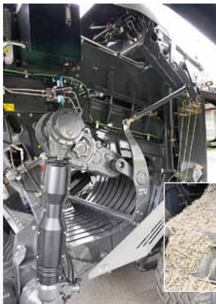
Der Druck im Steuerungszyylinder des Raffers dient als Überlastsicherung. Wird er zu hoch, blockiert das System automatisch den Rotor.
