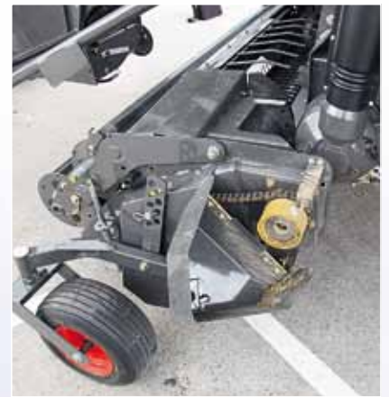
Die Deichsel ist für eine bessere Sicht etwas länger geworden. Die 2,35 m breite Pickup stammt von der großen Quadrant 3400. Sie hat auch die hydraulische Entlastung, wird aber nicht hydraulisch, sondern mechanisch samt Nockenschaltkupplung (rechtes Bild) angetrieben.
