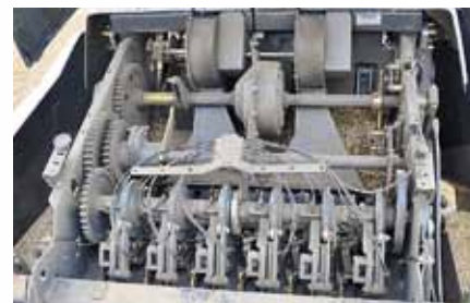
Die Einfachknoter samt Entlastungssystem kommen von der 3400, haben aber einen neuen Garnanleger und eine modifizierte Fußplatte. Die Schläuche der Zentralschmierung wurden hochgelegt, damit die Gebläse den Bereich besser sauber halten.
