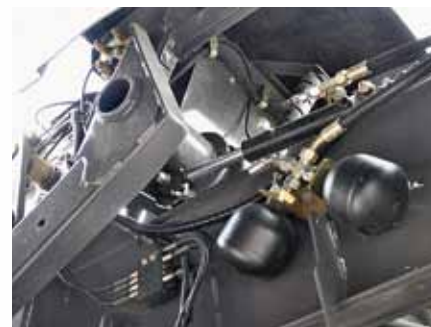
Der Druck im Steuerungszyylinder des Raffers dient als Überlastsicherung. Wird er zu hoch, blockiert das System automatisch den Rotor.
