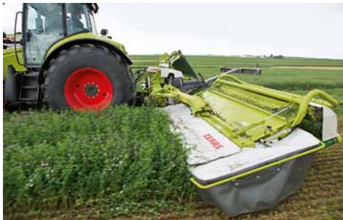
Die Mähwerke haben eine Schwerpunktaufhängung mit hydraulischer Anfahrtsicherung und hydropneumatischer „Active Float“-Entlastung. Die Bänder werden über zwei doppelwirkende Zylinder geklappt. Dabei werden sie automatisch abgeschaltet.
