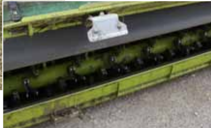
Angetrieben werden die 90 cm breiten und 2,80 m langen Förderbänder über zwei Ölmotoren. Unter dem Zinkenaufbereiter (Bild unten) sitzt eine Wanne, die Bröckelverluste vermeidet und als zusätzliche Abstützung für die Bänder dient.
