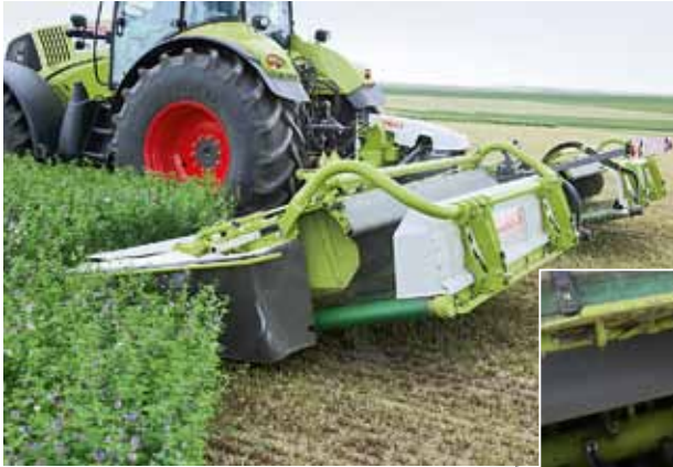
Angetrieben werden die 90 cm breiten und 2,80 m langen Förderbänder über zwei Ölmotoren. Unter dem Zinkenaufbereiter (Bild unten) sitzt eine Wanne, die Bröckelverluste vermeidet und als zusätzliche Abstützung für die Bänder dient.
