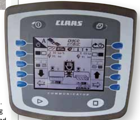
Auf dem ISO-Bus-Terminal „Communicator“ werden die Förderband-Drehzahlen als Prozentwerte angezeigt. Sie können (auch separat, z. B. am Hang) zwischen 200 und 1 200 U/min verstellt werden.
