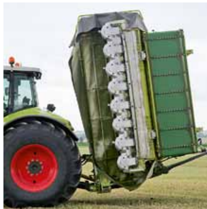
3,4 t wiegt die komplette Einheit laut Claas. Um unter vier Meter Transporthöhe zu bleiben, muss der Schutz außen eingeklappt werden, was auf Wunsch auch hydraulisch geht.
