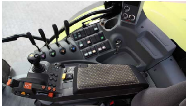
Beim CIS sitzen die mechanischen Ventile seitlich auf der Konsole – Nr. 1 ganz rechts, Nr. 4 ganz links.
