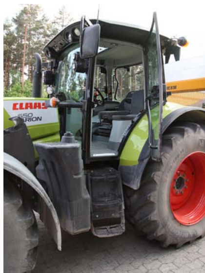
Damit die linke Tür nicht so groß ist, gibt es einen Hilfsposten. AdBlue braucht der Arion nicht und die Frontladerkonsolen können direkt an den Rahmen geschraubt werden.
