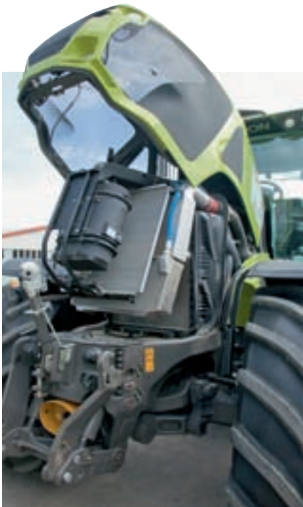
Газовые амортизаторы откидывают радиатор вверх. В основном двигатель FPT объемом 8,7 л почти не видно. Интегрированный фронтальный подъемник может поднимать до 6,8 т.
