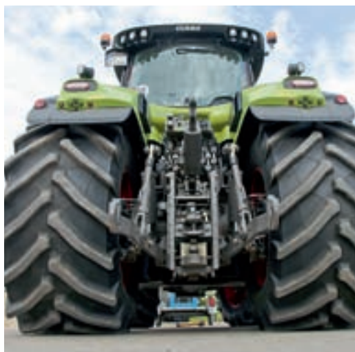
Чтобы передать 400 л.с. на почву необходима достаточная площадь опоры. С высокими (2,15 м) колесами и собственной массой 12,5 т Axion 950 может многое. Подъемник имеет грузоподъемность более 11 т, рычаги и быструю сцепку от Walterscheid.
