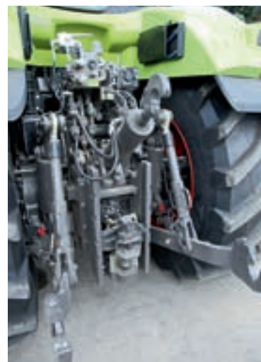
Тяги двух типов: кат. III или IV N. Сзади возможно до 6 распределительных клапанов, спереди – 2. Аксиально-поршневой насос мощностью 150 л/мин (по желанию – 200 л/мин).
