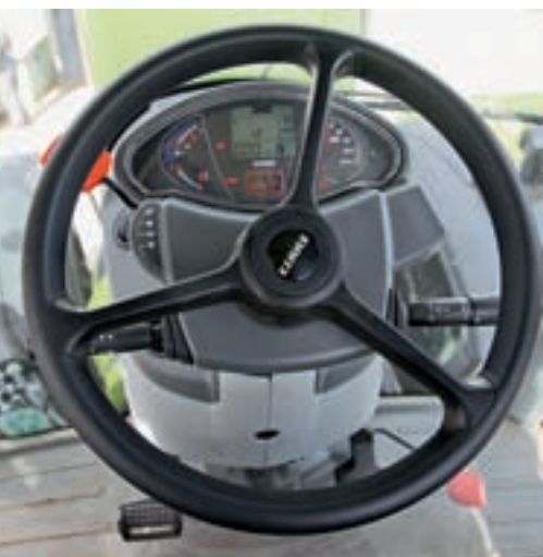
Держатель органов управления больше не выступает в области ног. Рулевое колесо выглядит грубовато. В рычаг реверса интегрирован стояночный тормоз (который, к сожалению, не управляет тормозом прицепа).
