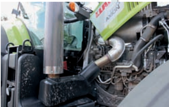
Катализатор SCR полностью спрятан под капотом. Благодаря этому глушитель достаточно узкий. Снизу находится полурама, в которую вмонтирован двигатель.
