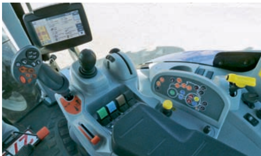
Бесступенчатая коробка передач AutoCommand имеет вместо четырех диапазонов хода только два. Многофункциональный подлокотник SideWinderII и цветной сенсорный экран IntelliView III теперь относятся к серийной комплектации.
