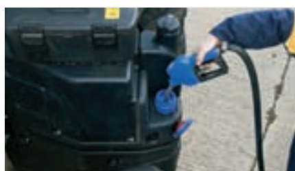
Помимо топливного бака емкостью 330 л, здесь же расположен бак AdBlue с более тонкой горловиной, чтобы не перепутать при заправке. При покупке трактора New Holland клиент получает дополнительно контейнер с 1000 л AdBlue и электрическим насосом.
