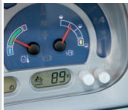
Уровень AdBlue высвечивается на жидкокристаллическом экране в процентах. При поломке SCR или отсутствии AdBlue мощность двигателя существенно понижается.
