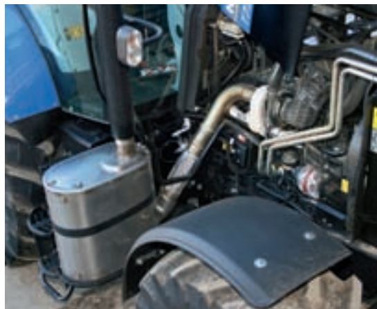
Большой катализатор SCR расположен справа под обшивкой. Жидкость AdBlue впрыскивается в систему выпуска ОГ. Подающий насос работает от напряжения в 24 вольт.
