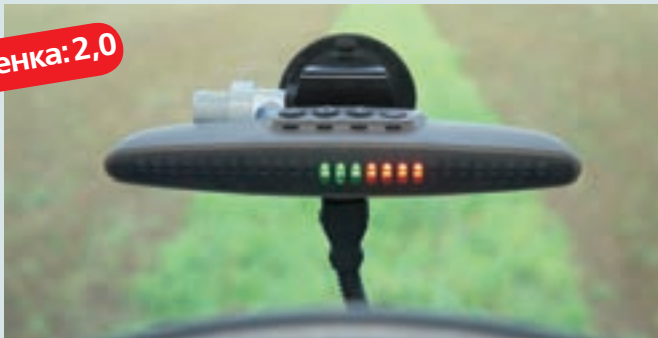
Lightbar от John Deere является базовым элементом, способным «расти», в зависимости от предъявляемых требований.
