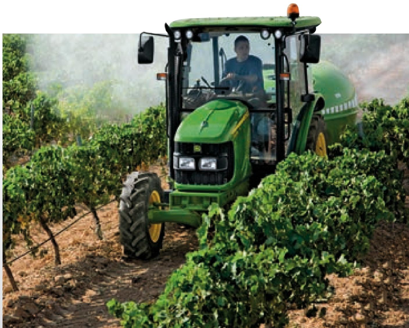
Die Sicht nach vorn und zur Seite ist selbst mit angebautem Frontlader ausgezeichnet. Im hinteren Bereich gibt es keine C-Säule und durch die abgerundeten Glasflächen genießen Sie einen ungehinderten Blick nach allen Seiten. Die Glasdachluke als Wahlausrüstung ist eine große Hilfe bei Laderarbeiten.
