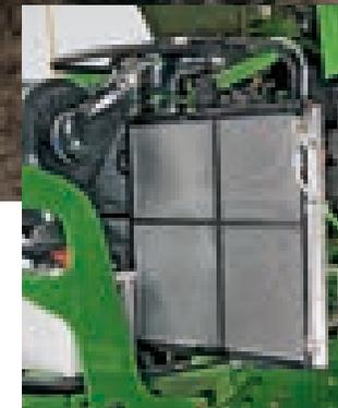
Die Grobschmutzabweiser fangen bereits einen Großteil der Schmutzpartikel ab. Sie sind leicht entnehmbar, so dass die Reinigung zum Kinderspiel wird.
