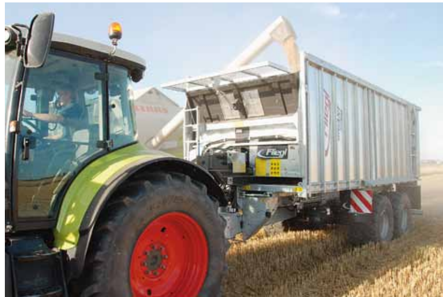
Der Fliegl-Abschieber war mit einer Wiegeeinrichtung ausgestattet. So konnten wir die Gewichte beim Abbunkern auf dem Feld ermitteln.
