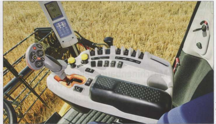
Ergonomie: Joystick und Schalter sind griffgünstig angeordnet. Der Monitor sitzt am A-Holm.
