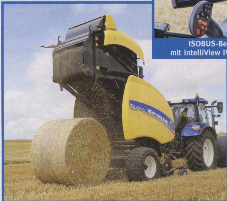
Variable Ballenpresse mit vier Endlosriemen
