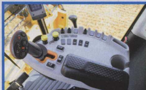
Rechte Bedienkonsole mit neuem Multifunktionshebel
