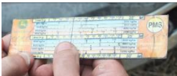
Рисунок 7 – Линейка для определения процента потерь зерна за молотилкой комбайна
