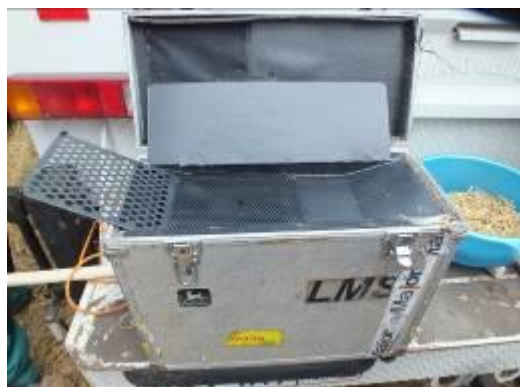
Рисунок 6 – Малогабаритный сепаратор для отделения зерна от солоистой массы
