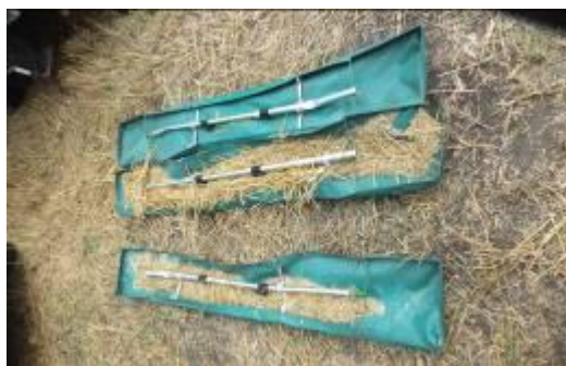
Рисунок 5 – Лотки для сбора потерь зерна за комбайном
