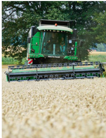
Der Hangausgleich über die Portalachsen stellt die gesamte Maschine bis 11,5° Seitenneigung automatisch waagrecht. Die 60er Serie hat im Vergleich zum 56er ein besseres Lichtkonzept mit mehr Scheinwerfern.
