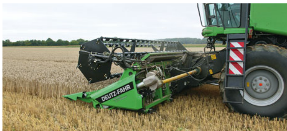
Das „Vario-Star“-Schneidwerk von Geringhoff hat keine Riemen oder Ketten. Die Schnecke wird per Welle angetrieben, Messerbalken und Haspel hydraulisch. Der 5,50 m breite Vorsatz bringt allerdings stolze 2 470 kg auf die Waage.
