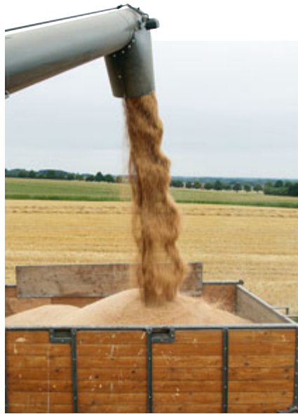
Überladehöhe und -weite sind prima, die Kornqualität ebenfalls. Der Korntank fasst aber maximal 6,5 statt der angegebenen 7,5 m³, und das Abbunkern dauert etwa 1,5 Minuten.
