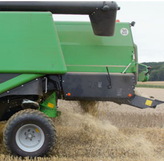
Die mechanisch angetriebenen Heuling-Spreuverteiler leisteten ordentliche Arbeit und sind einfach schwenkbar, um an die Mechanische Siebverstellung zu kommen. Die Strohqualität blieb gut erhalten, der Häcksler wird einfach nur durch Umlegen des Strohleitbleches aktiviert.
