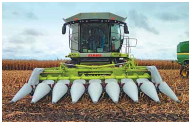
Фото 1. Зернозбиральний комбайн Lexion 770 з кукурудзяною жаткою Conspeed 8-70 FC на полях групи компаній «Росток Холдинг»
