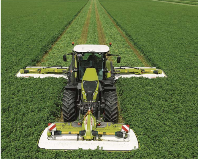
Claas DISCO 1100 - Mit 10,70 m Arbeitsbreite die größte angebaute Mähkombination mit Aufbereiter. (c) Claas
