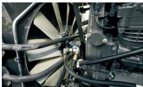
Гідравлічний привід вентилятора із функцією реверса
