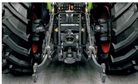
Тяговий брус, 3-х точкова навіска IV категорії, регульований по висоті фаркол, механізм відбору потужності
