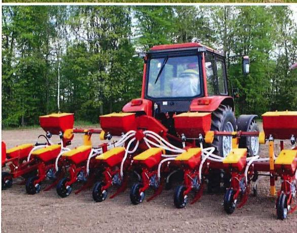
**СЕЯЛКИ ТОЧНОГО ВЫСЕВА СТВ
